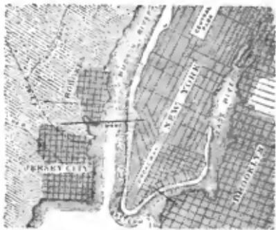
Der Tunnel-Eingang in Jersey City befindet sich an der Ecke der Jersey Avenue und der 15. Straße. Von dort soll der Tunnel ca. 1030 m bis zum Hudson, dann ca. 1650 m unter dem Flussbett in schwacher Krümmung nach Norden hin an das New-Yorker Ufer in der Nähe der Morton Street gebra und von da schließlich in südlicher Krümmung ca. 900 m weit bis zur Ausmündung an einer durch die Stadt-Verwaltung bestimmten Stelle geführt werden.
