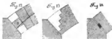
erst nach dem Schlusse des Gewölbes, aber noch vor dem Anrücken, schließen. Mit dem Anrücken muss man aber warten, bis der Mörtel in dem nachträglich eingesetzten Theile ebenso vollkommen erhartet ist, wie im anfänglich ausgeführten Kampertheile, da sich sonst die Stützlinie am Kämpfer nach unten senkt.
