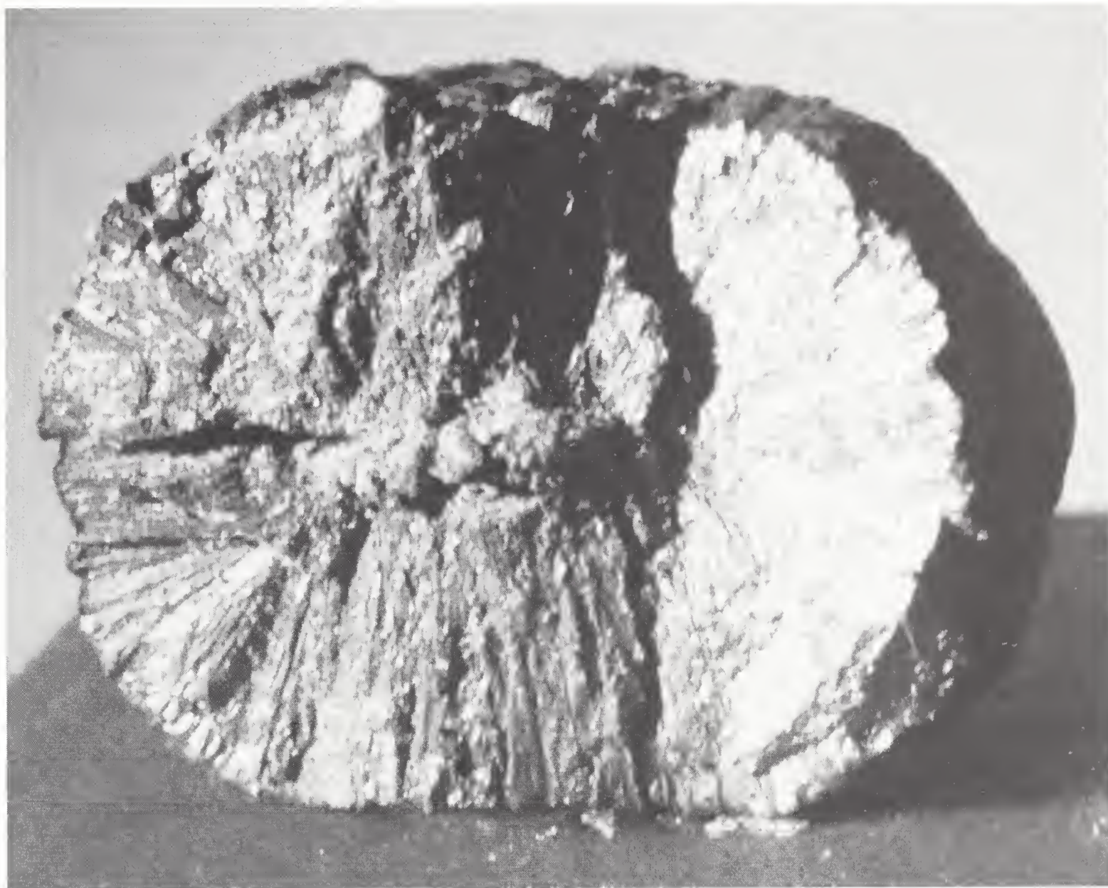
Fig. 2 - Pirite nodulare in sezione di 20 mm circa di diametro. / Pyrite lump section of around 20 mm in diameter.
