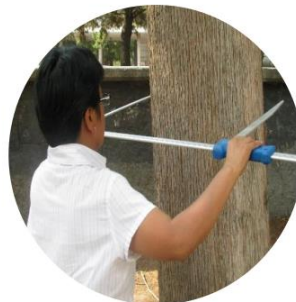
2. Se mueve la regleta para posicionar la cuchilla fija sobre el tronco.
