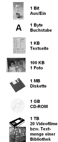
Bild 1.16 Einige praktische Beispiele, um ein Gefühl für die Größe „Bit“ zu erhalten
