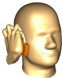
Fig. 102 Las antenas de telefonía móvil sufren en general alteraciones de su impedancia y reducción de la eficiencia de radiación debido a que la cabeza es un medio dieléctrico con pérdidas.
