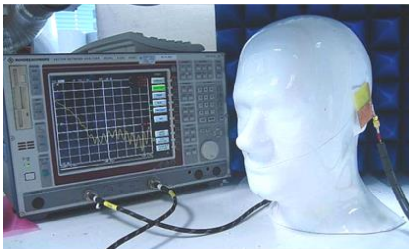
Fig. 23 Analizador de redes para la medida del coeficiente de reflexión de antenas. El ejemplo muestra la medida de una antena enganchada a la mejilla de un phantom head (maniquí de cabeza humana) que contiene líquidos que emulan el tejido humano. Gentileza de la empresa de tecnología Fractus, Barcelona.
