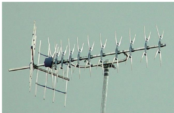
Fig. 255 Izquierda) esquema básico de un reflector diédrico. La fuente se sitúa a una distancia d del vértice. El ángulo del reflector es \alpha . Derecha) aplicación de un reflector diédrico simplificado con varitas para aumentar la directividad de una agrupación Yagi-Uda. Nótese que las varitas tienen el mismo sentido que la polarización de la antena y es vertical en este caso.
