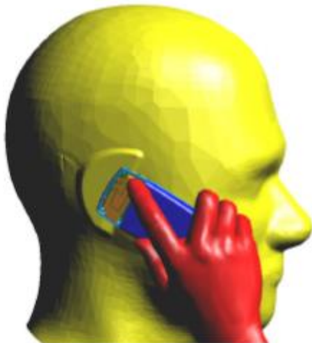
Fig. 25 La eficiencia de radiación y de antena se pueden ver reducidas por la presencia de factores externos como la cabeza y la mano humana. La utilización de simuladores electromagnéticos resulta clave para un análisis sistemático: diferentes posiciones de la mano, del dedo sobre la antena, por ejemplo. En la figura, modelo numérico FDTD de cabeza, mano y antena de teléfono móvil. Con los simuladores es posible determinar la eficiencia (entre otros muchos parámetros como los descritos en este capítulo) de la antena en presencia de un medio complejo.
