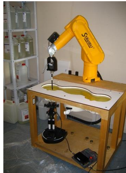
Fig. 105 Sistema de medida de SAR Dasy-4 que consta de un brazo articulado con una sonda de campo eléctrico que permite medir E_x , E_y y E_z a partir de dipolos elementales. Gentileza de la empresa de tecnología Fractus, Barcelona.
