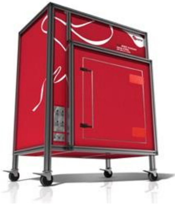
Fig. 212 Cámara de reverberación para la medida de sistemas con múltiples antenas: sistemas de diversidad y MIMO. Gentileza del profesor David A. Sánchez del Dept. Teoría de la Señal y Comunicaciones de la Universidad Politécnica de Cartagena y de la empresa EMite Ing, Murcia.
