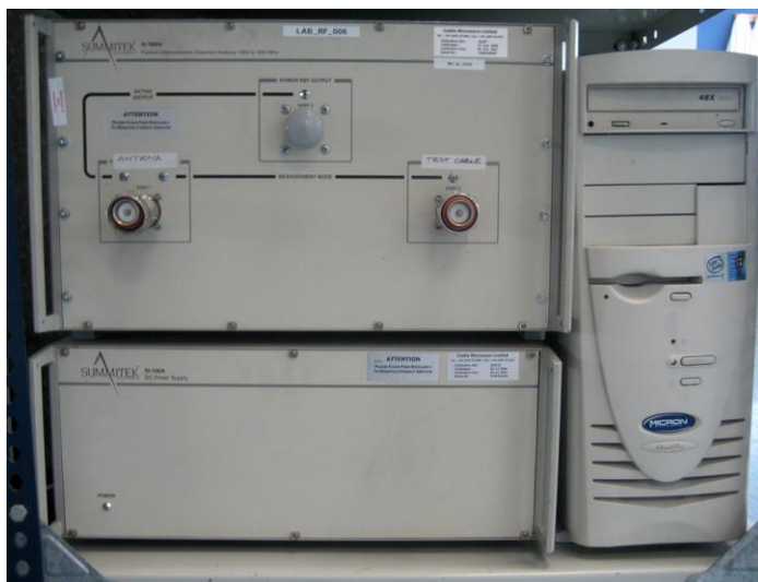
Fig. 185 Aparato de PIM: medida de productos de intermodulación. Gentileza de la empresa de tecnología Fractus, Barcelona.
