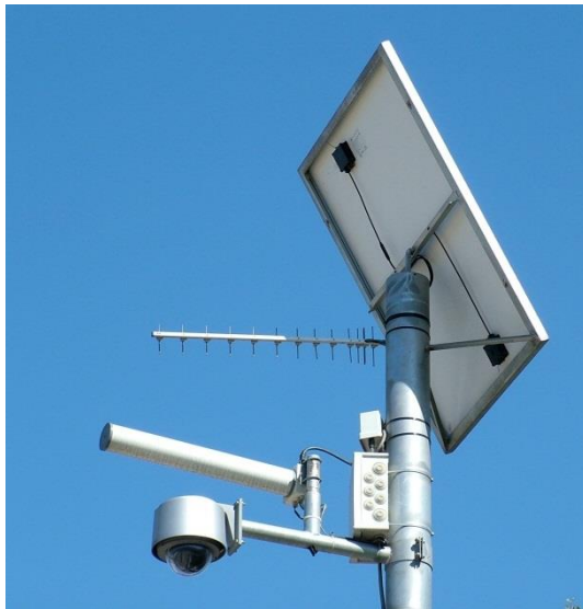
Fig. 217 Sistema de telemetría para emitir de datos de video utilizando una antena Yagi-Uda operando alrededor de los 2.5GHz. Su directividad y sencillez del sistema de alimentación resulta útil para radioenlaces en lugar de instalar un cableado costoso en cuanto a infraestructura. Gentileza del Dr. Edouard Rozan de la empresa Wireless BCN de Barcelona
