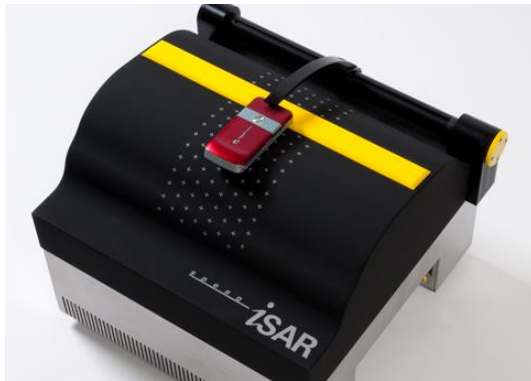
Fig. 107 Medidor compacto de SAR el cual emula la superficie curvada de la mejilla humana. Sistema formado por un conjunto de 256 sensores capaces de medir el SAR de un dispositivo móvil de forma rápida (<1seg).
