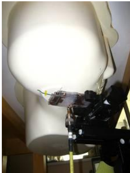
Fig. 105 Sistema de medida de SAR Dasy-4 que consta de un brazo articulado con una sonda de campo eléctrico que permite medir E_x , E_y y E_z a partir de dipolos elementales. Gentileza de la empresa de tecnología Fractus, Barcelona.
