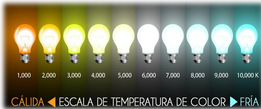
Figura 1. Temperatura de color correlacionada, desde valores de 1000 K, consideradas temperaturas cálidas, hasta 10000 K, consideradas temperaturas frías. Imagen obtenida de la Federación de Asociaciones Europeas de Luminarias y Componentes para Luminarias.
