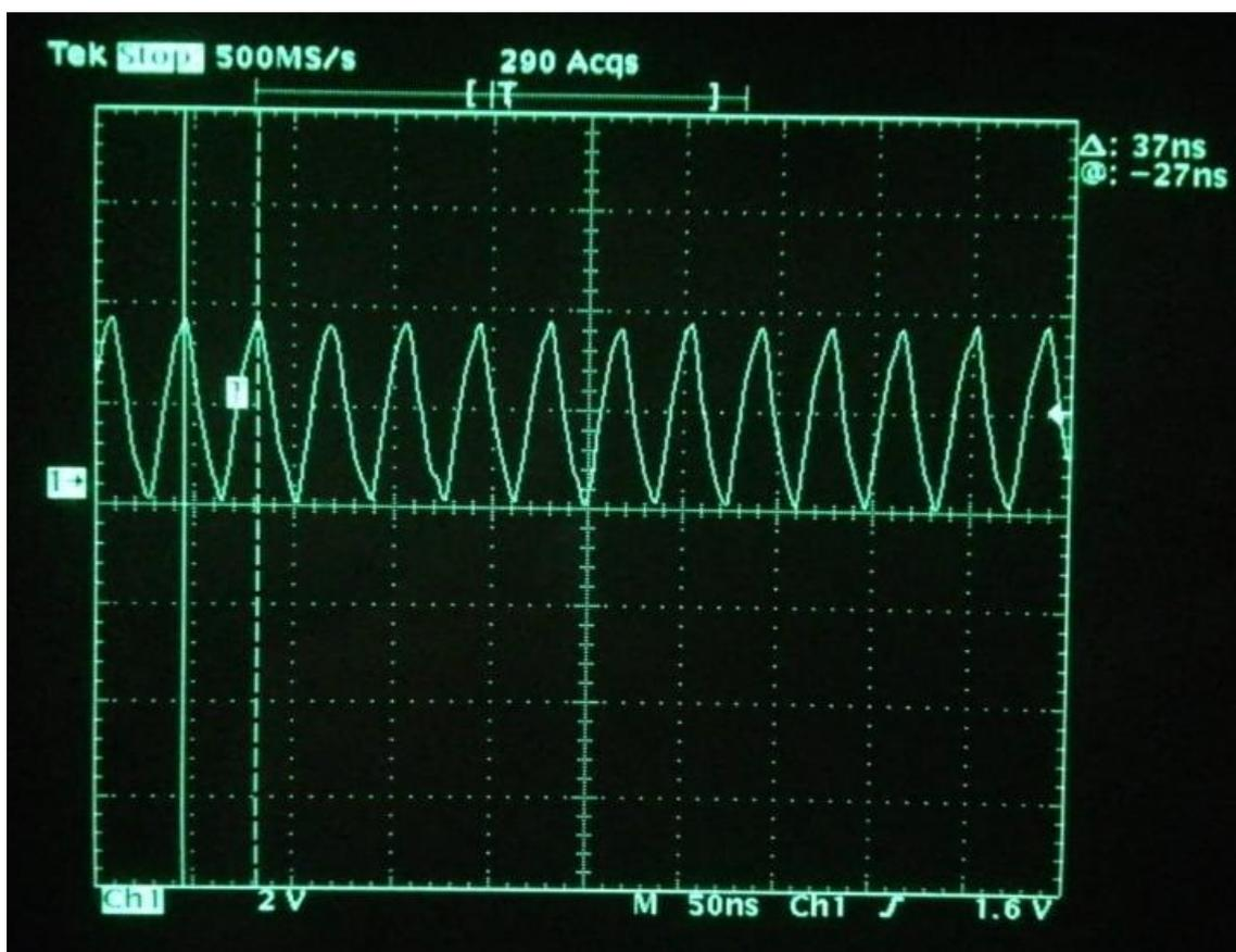
*Figura 4.24: Frecuencia de reloj proveniente del AFE*
