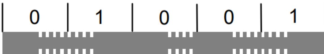
*Figura 1.15: Modulación de la portadora correspondiente con la respuesta de un PICC.*
