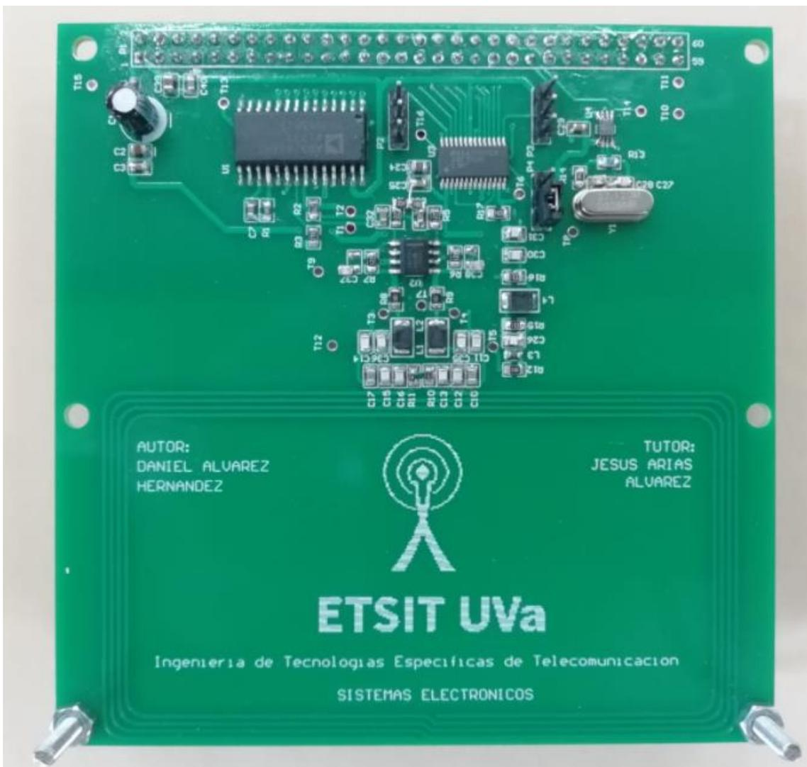
*Figura 4.22: Fotografía de la PCB del AFE*
