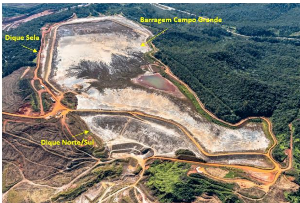
Figura 4-1 - Localização das principais estruturas da barragem. (GISmineral, 2022)
