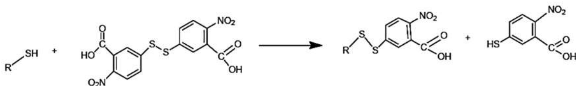
Fig. 2. Mecanismul de interacțiune a tiolilor cu acidul 5,5'-ditiobis-(2-nitrobenzoic) la pH=8
