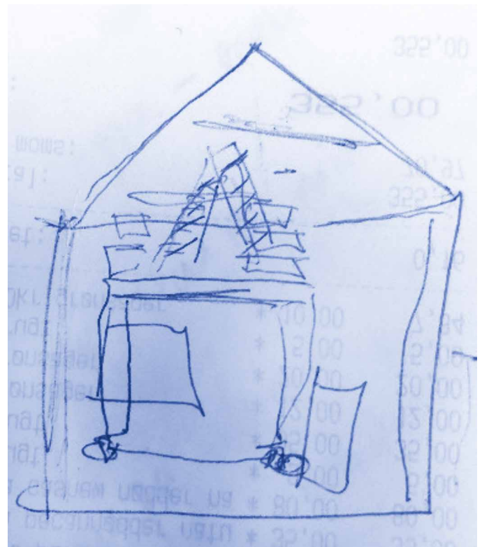
FIGUR 22: BORIS' TEGNING AF SELVBYGGET STILLADS AF STIGE OG BETONELEMENTER
