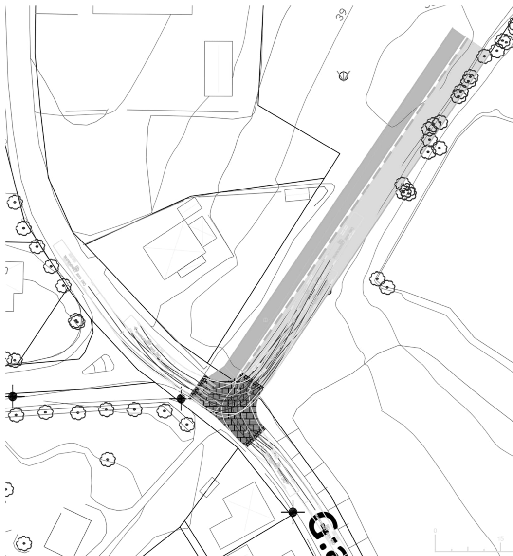
Figur 20 Körspårskontroll med brandbil i korsningen med Gamla Landsvägen.
