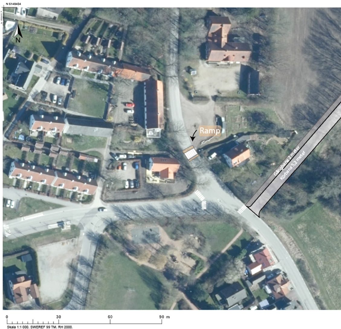
Figur 19 Föreslagen utformning av korsningen Steglarpvägen/Gamla Landsvägen/anslutning planområdet enligt alternativ 2 upphöjd övergångsställe vid skolbusshållplatsen. Källa: Tyréns Kartunderlag: Lantmäteriet.
