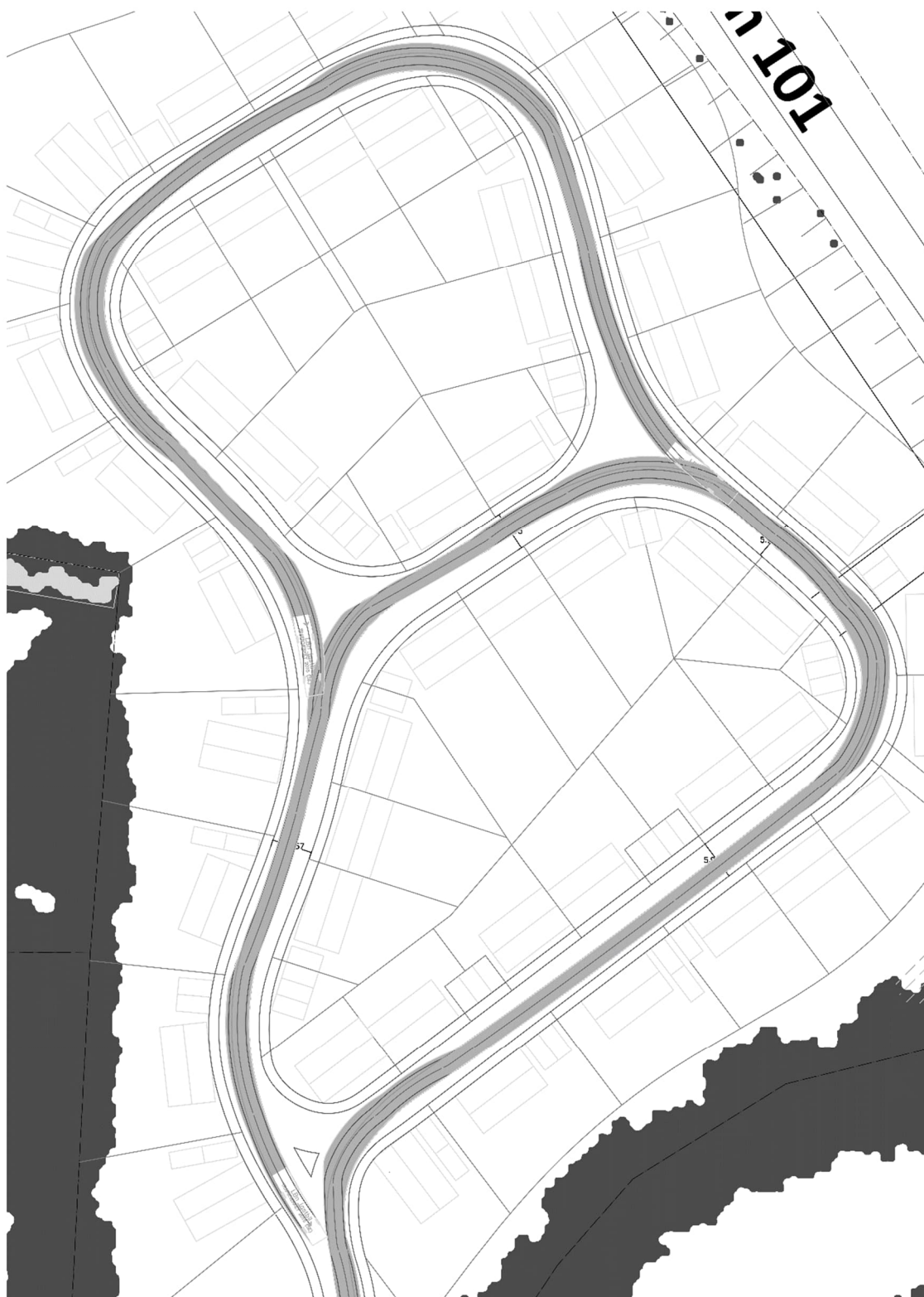
Figur 21 Körspårskontroll inne i planområdet med 12 m lång lastbil, motsvarande brandbil.
