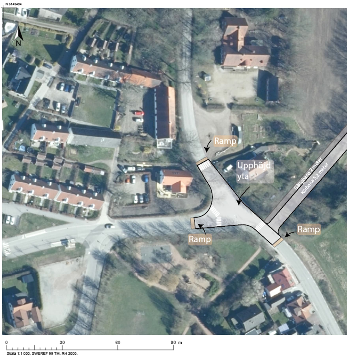
Figur 18 Föreslagen utformning av korsningen Steglarpsvägen/Gamla Landsvägen/anslutning planområdet enligt alternativ 1 upphöjd korsning. Källa: Tyréns, Kartunderlag: Lantmäteriet.
