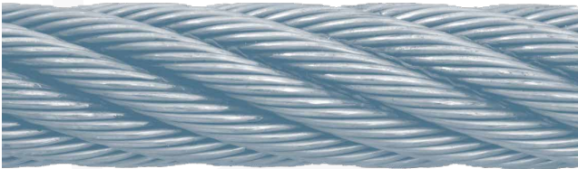
Abb. 36: Zustand bei 0% der Biegewechsel bis Bruch (Neuzustand)
