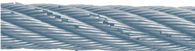
Abb. 40: Zustand bei 80% der Biegewechsel bis Bruch
