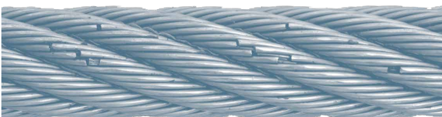
Abb. 39: Zustand bei 60% der Biegewechsel bis Bruch
