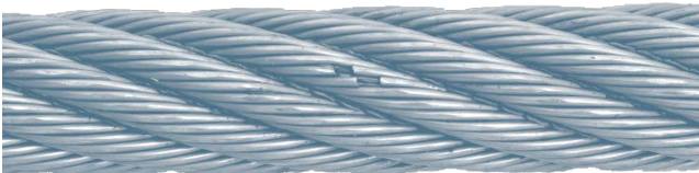
Abb. 38: Zustand bei 40% der Biegewechsel bis Bruch
