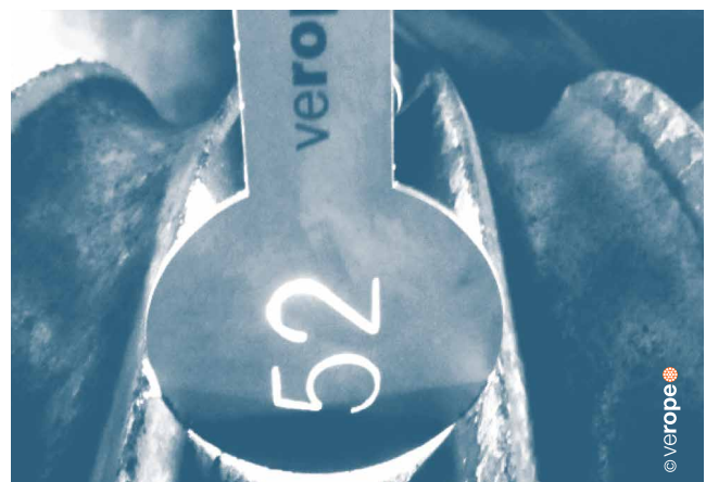
Abb. 74: Rillenlehre (hier in zu enger Seilrille)
