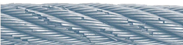
Abb. 41: Zustand bei 100% der Biegewechsel bis Bruch (Zone nahe Seilbruchstelle)
