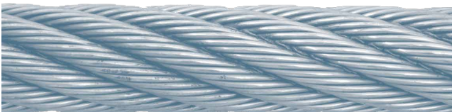
Abb. 37: Zustand bei 20% der Biegewechsel bis Bruch
