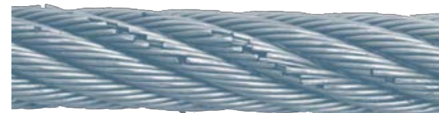
Abb. 40: Zustand bei 80% der Biegewechsel bis Bruch
