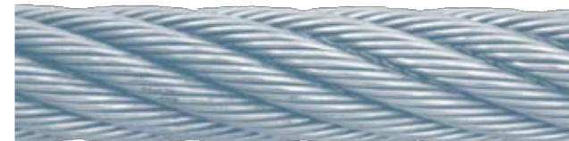
Abb. 37: Zustand bei 20% der Biegewechsel bis Bruch
