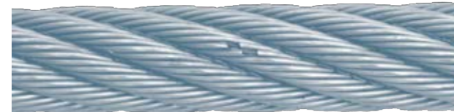
Abb. 38: Zustand bei 40% der Biegewechsel bis Bruch
