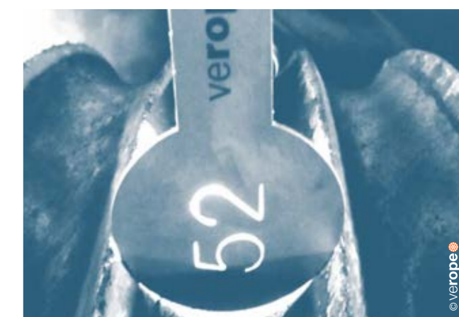
Abb. 74: Rillenlehre (hier in zu enger Seilrille)
