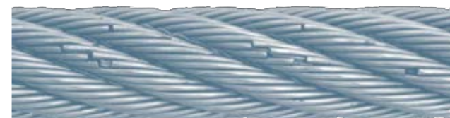
Abb. 39: Zustand bei 60% der Biegewechsel bis Bruch
