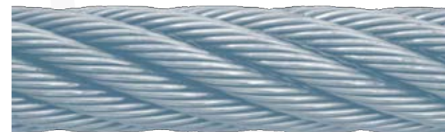
Abb. 36: Zustand bei 0% der Biegewechsel bis Bruch (Neuzustand)
