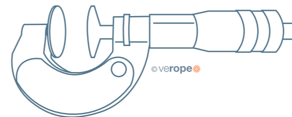
Abb. 11: Bügelmessschraube mit breiten Messflanken
