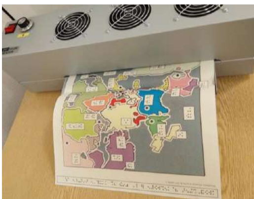
Illustration 30: Production d'un dessin thermogonflé
