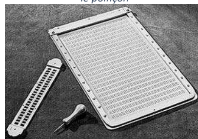
Illustration 20: la tablette, la réglette et le poinçon
