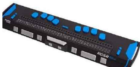
Illustration 23 : La plage braille, le clavier et la barrette de lecture.
