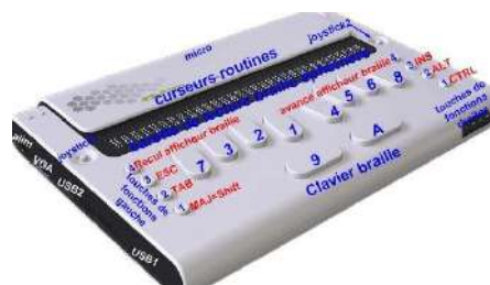
Illustration 22 : L'ordinateur braille ESYTIME d'Eurobraille
