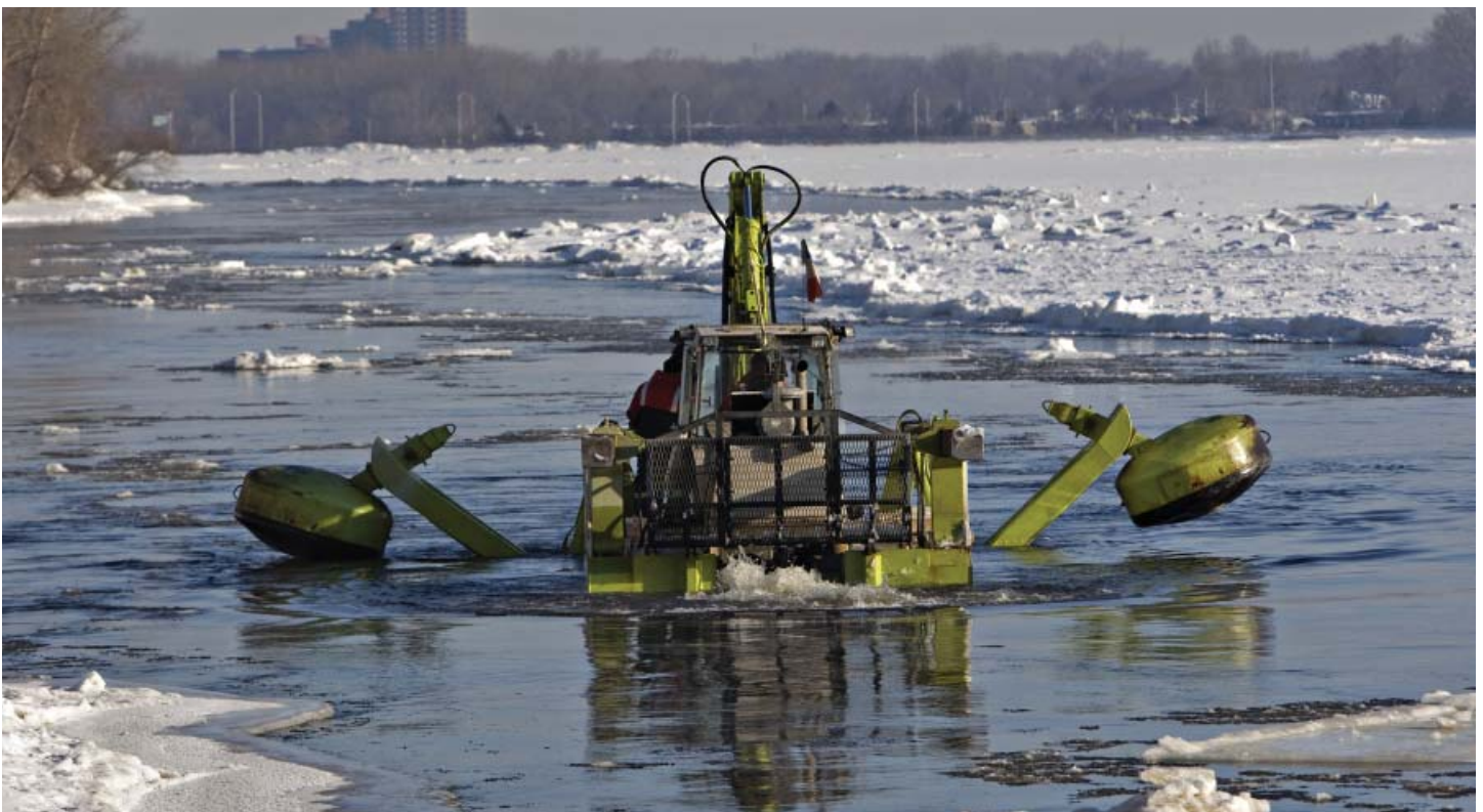
La rétrocaveuse amphibie « grenouille » est à l'œuvre dans la rivière des Prairies. (27.01.2009) Crédit : © Ivanoh Demers, La Presse
