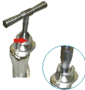
Después de la retirada de la guía interna, la fresa manual se ahonda a la ranura mostrada en el detalle
