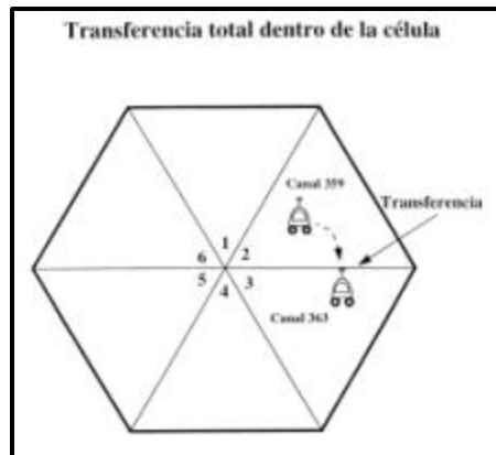
Figura 7. Transferencia Total dentro de la Célula (Motorola, 1997)
