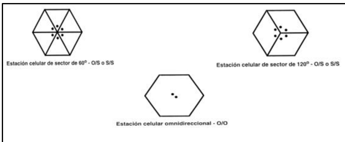
Figura 8. Configuraciones O/S y S/S (Motorola, 1997)
