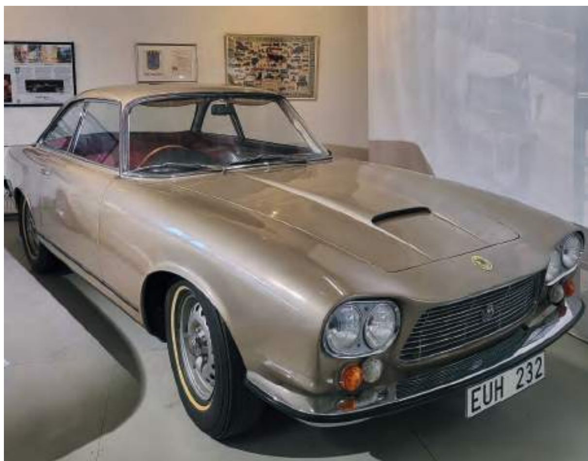
Gordon Keeble 1965, första engelska bilen med glasfiberkaross, tillverkad i endast 99 ex. troligen en av ytterst få bevarade.
