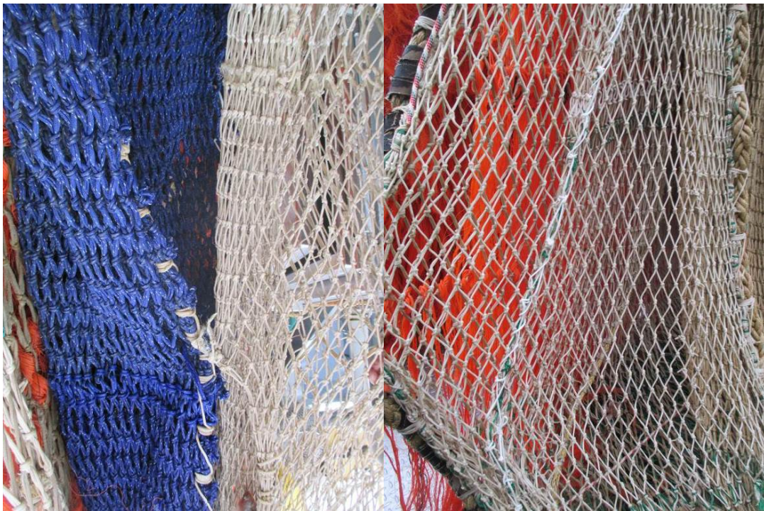
Figuur 38. links een foto van de twee kuilen gebruikt in het testnet. Het paarse dubbel gebreide netwerk is de onderkuil, het witte netgaren is de bovenkuil. Rechts de bevestiging van het scheidingspaneel aan de zijkant van het net.
