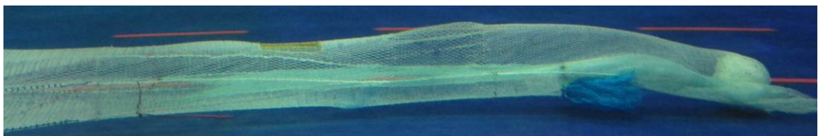
Figuur 65. In het bovenstaande figuur wordt de netconfiguratie van de ARM22 weergegeven. Een horizontaal scheidingspaneel scheidt de vangst in een boven en een onderkuil. Boven het scheidingspaneel is een ontsnappingspaneel met vierkante mazen aangebracht. Dit ontsnappingspaneel is zichtbaar in bovenstaande foto in de vorm van geel netwerk in de bovenzijde van het net.
