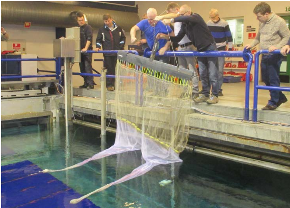
Figuur 33. Testen van een schaalmodel PulsWing met verschillende netinnovaties in de flume tank in Hirts-hals in januari 2015.
