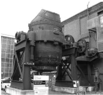
Основни Бесемеров процес Сиг-нија Томаса.
