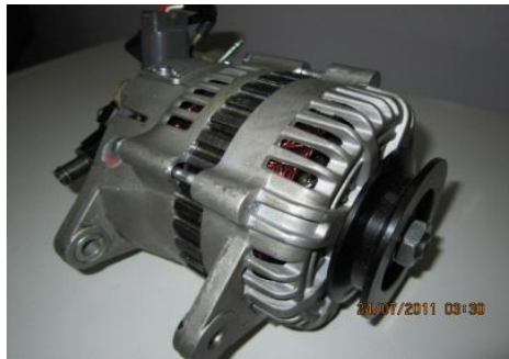
شكل (ب-2-3) المولد الكهربائي المستمر.
