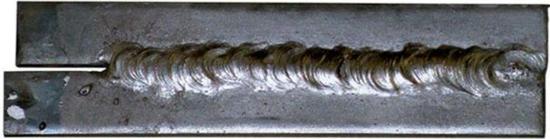
شكل رقم ( 7 - 11 ) يوضح عملية لحام قطعتين متقابلتين
