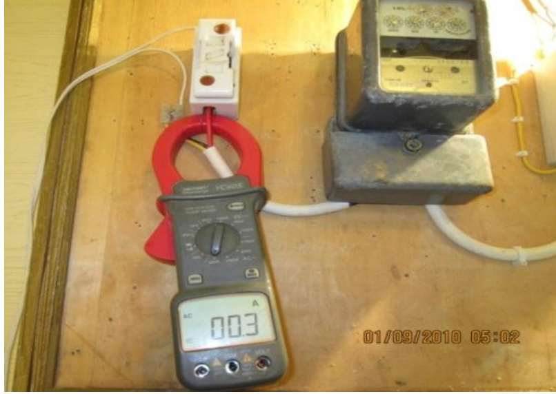
الشكل (4-53) قياس قيمة التيار المسحوب لحمل (مصباح) بواسطة الكلامبيتر.
