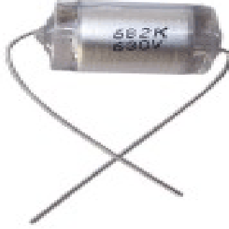
الشكل (5-13) شكل متسعة البولستيرين
