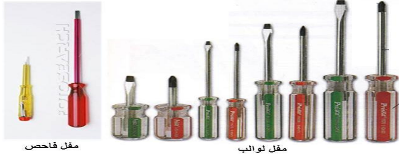
شكل ( 7 - 1 ) يوضح المفل بأنواعه المختلفة .
