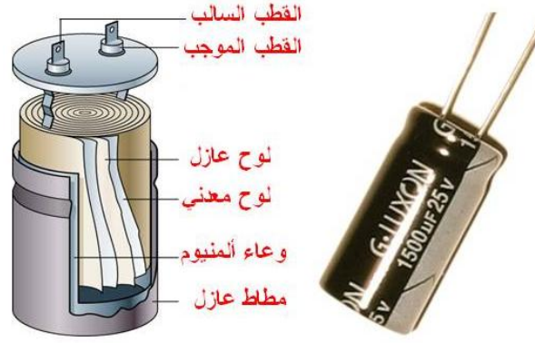
الشكل (3-5) تركيب المتسعة الالكتروليونية (المستقطبة) وأشكالها.
