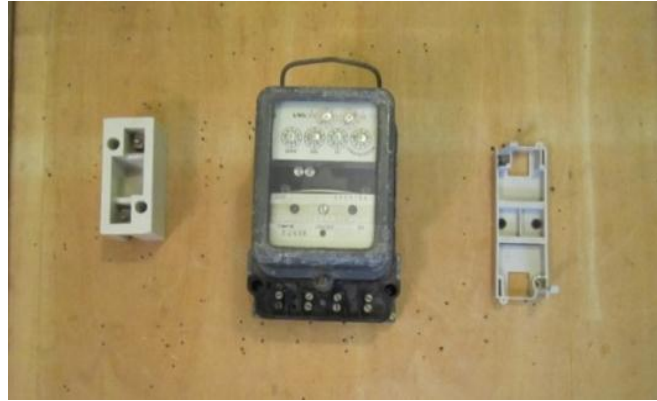
الشكل (4-50) تثبيت عداد الساعة 1Ph وقاعدة المصهر وغلاف القاطع على اللوحة.
