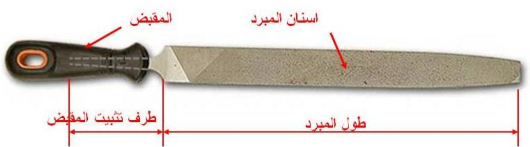
شكل ( 1 - 2 ) يوضح أجزاء المبرد
