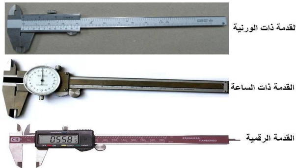
شكل ( 1 - 3 ) يوضح أنواع قدمة القياس
