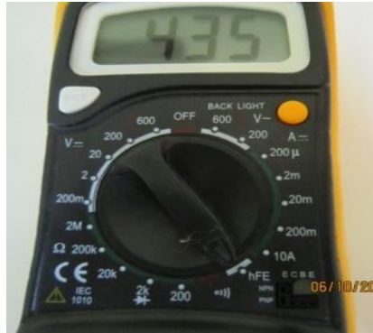
الشكل (7-17) فحص قيمة hfe لترانسستر نوع pnp برقم BC214 .
