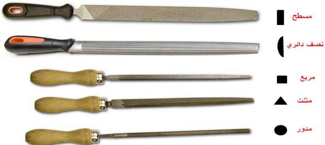
شكل ( 2 - 2 ) يوضح بعض أنواع المبارد
