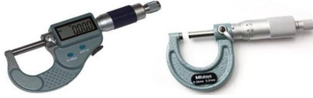
شكل ( 1 - 4 ) يوضح الميكروميتر بنوعيه الرقمي والميكانيكي
