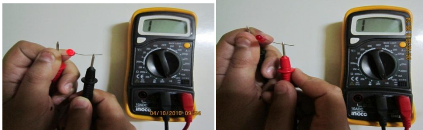
الدايدود الضوئي لايشع (أنحياز ه عكسي) الدايدود الضوئي يشع (أنحياز ه امامي)
