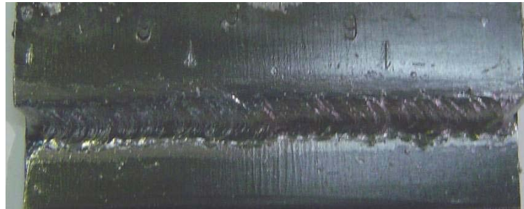
الشكل ( 7 - 12 ) يوضح لحام القطع المترابكة
