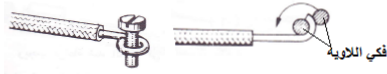
شكل ( 1-36 ) طريقة حني نهاية السلك شكل ( 1-37 ) يمكن إدخال لولب في الحلقة .
