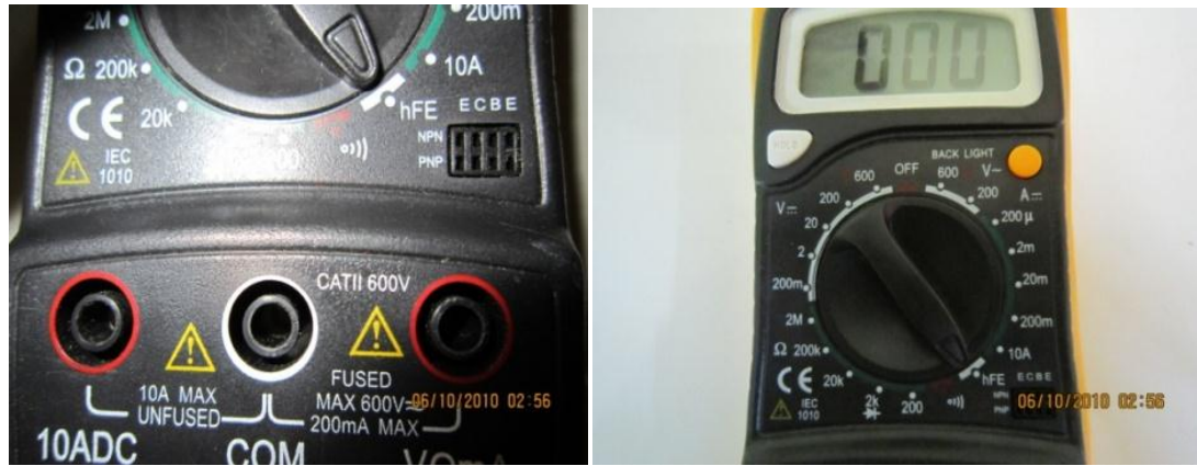
شكل رقم (7-15) جهاز الملتى تستر مهياً على وضع قياس h_{fe} أو ( Beta ) .
