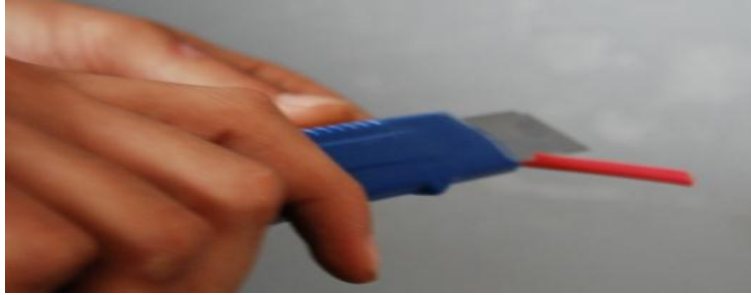
شكل رقم (1-17) يوضح طريقة قشط سلك مفرد بواسطة سكين
