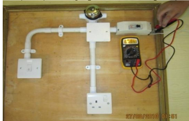
الشكل (4-27) قياس قيمة جهد مصدر التغذية بواسطة AVO
