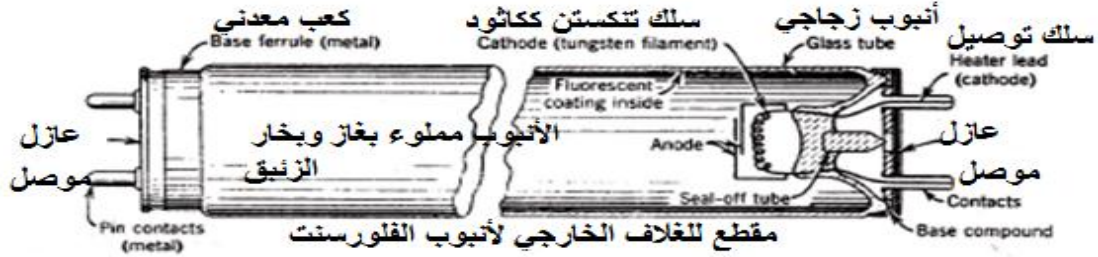
الشكل (4-11) أجزاء مصباح الفلورسنت
