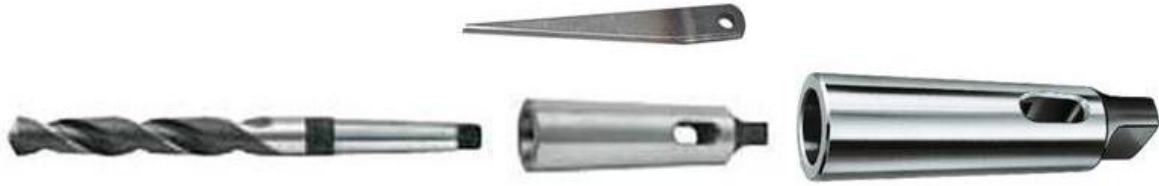
شكل ( 4 - 3 ) يوضح بريمة ذات ساق مسلوب مع مصغرة أقطار ( بوشة ) مع آلة إخراج البريمة
