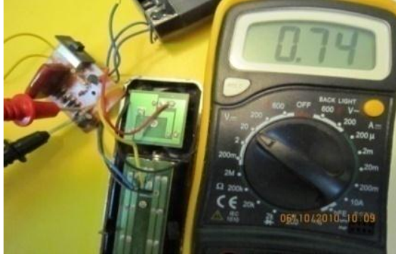
الشكل (7-4) فحص صلاحية الدايمود الاعتيادي نوع Si وهو مركب في الدائرة.
