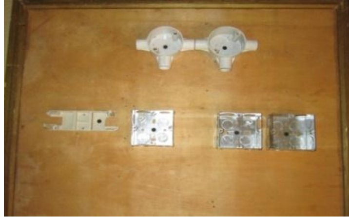
الشكل (4-34) تثبيت الصناديق على لوحة التدريب الخشبية
