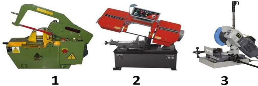
شكل ( 5 - 9 ) يوضح بعض أنواع المنشار الآلي
