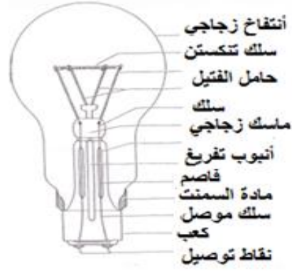
الشكل ( 10- 4 ) شكل وأجزاء مصباح التنكستن .
