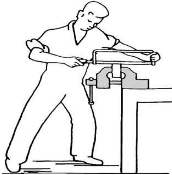
شكل ( 4 - 1 ) يوضح الإرتفاع الملائم لطاولة العمل
