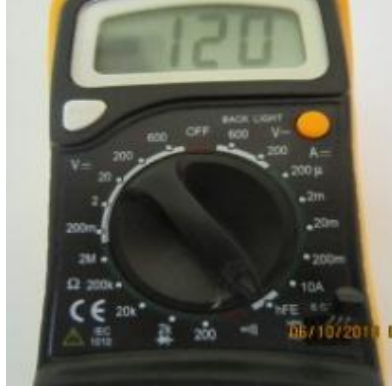
الشكل (7-16) فحص قيمة hfe لترانسستر نوع npn برقم BC337 .
