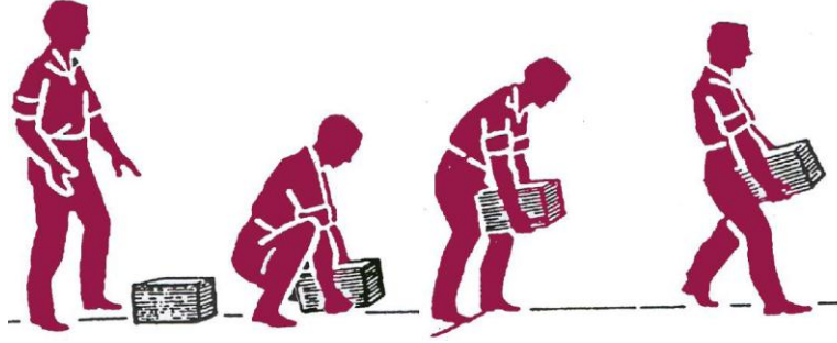
شكل ( 1 – 10 ) يوضح الطريقة الصحيحة لرفع الاحمال
