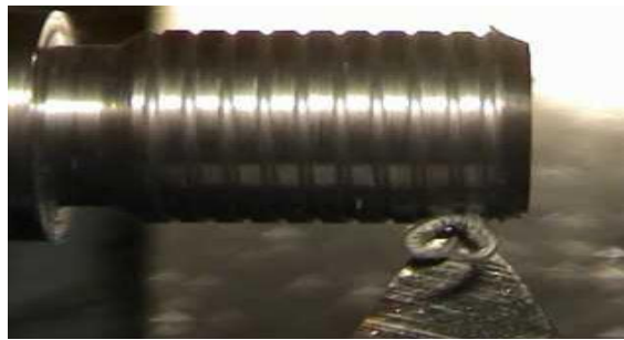
شكل ( 8 - 27 ) يوضح عملية قطع السن في قطعة العمل
