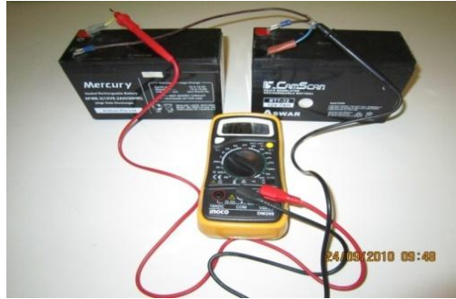
الشكل (6-14) قياس جهد البطاريتين الجافتين الموصلتين على التوالي .
