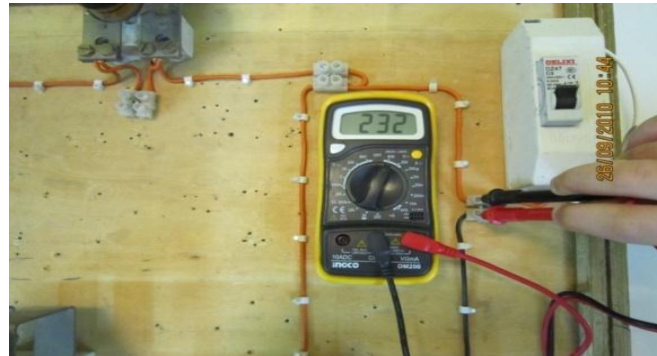
الشكل (30-5) قياس قيمة جهد المصدر المتناوب المغذي 220v/50Hz .
