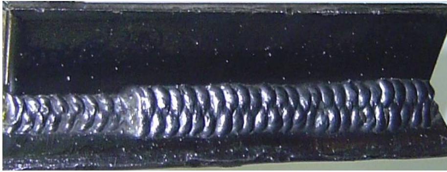
شكل ( 7 - 14 ) يوضح بناء خطوط اللحام وتداخلها
