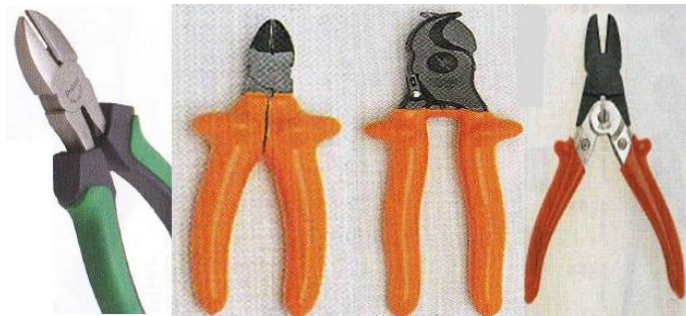
شكل رقم (1-15) يوضح أنواع وأشكال من قاطعة الأسلاك الكهربائية المعزولة .
