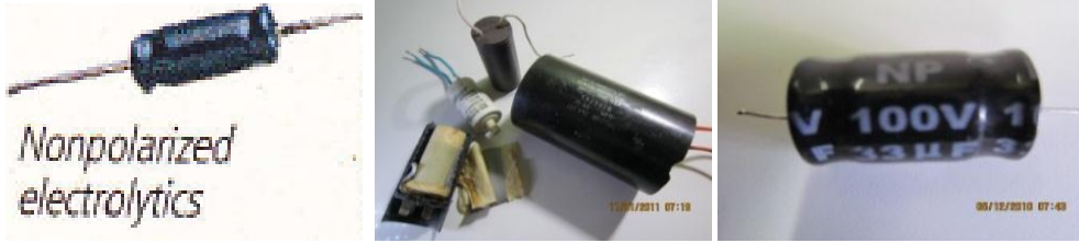
الشكل (5-8) شكل المتسعة غير المستقطبة الالكتروليتية .
