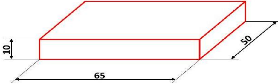
شكل ( 2 - 4 ) يوضح قطعة العمل ( الابعاد بالملترات )
