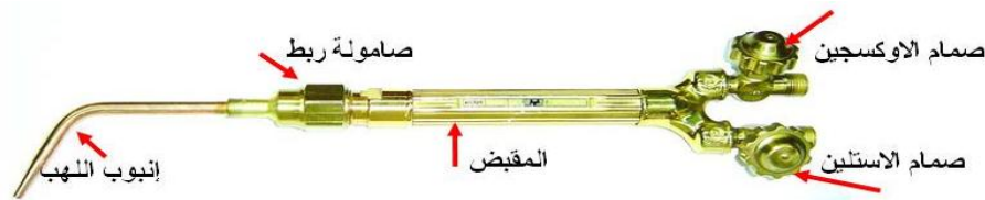
شكل ( 7 - 20 ) يوضح أجزاء مقبض اللحام ( المشعل )
