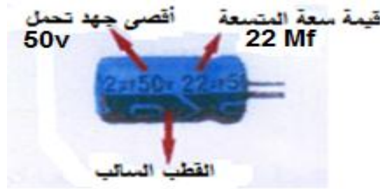
الشكل (4-5) قراءة مواصفات متسعة الكتروليتية .
