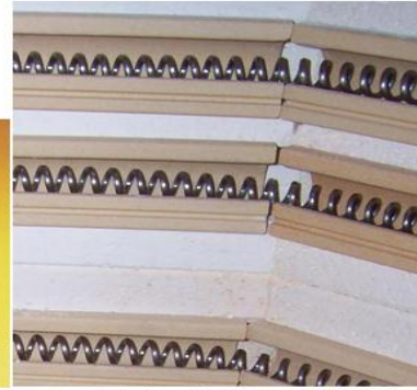
اسلاك التسخين الكنثال داخل الفرن
