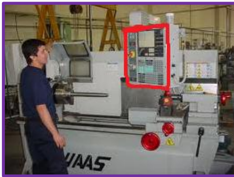
شكل (2-4) ماكينة خراطة CNC يتحكم بها
