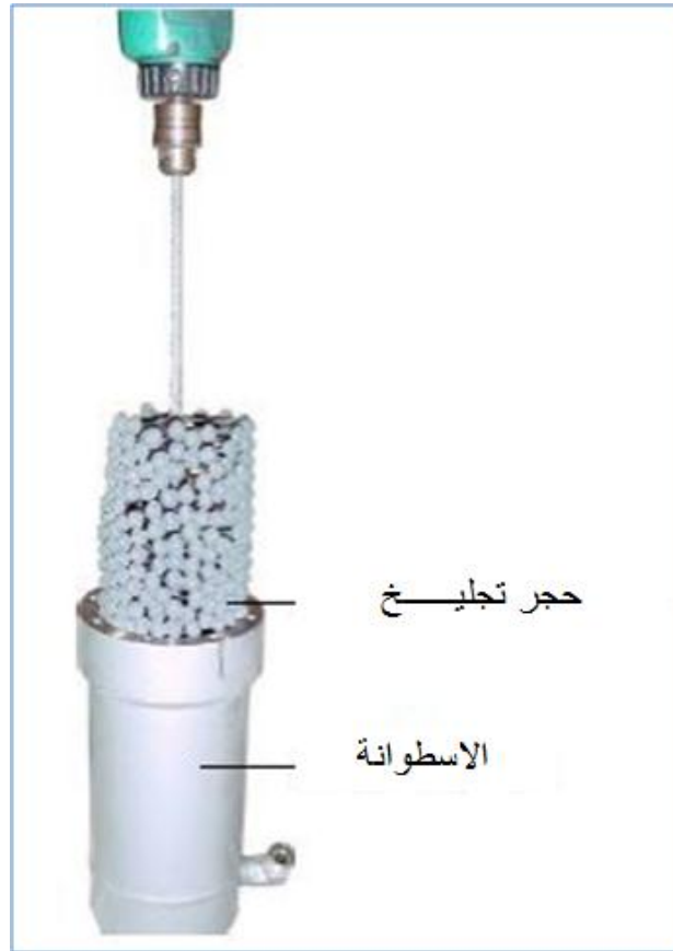
الشكل ( 11-2 ) عملية الصقل والتجليخ الداخلي للاسطوانة
