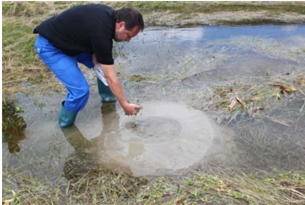
13-101. kép. Mintavétel a buzgárból, a buzgár kúpjának lehetőleg mindkét oldala képviseltesse magát a mintában
