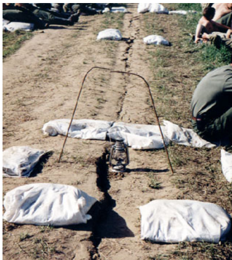
13-78. kép. Elmozdulás mérés a 2000. évi Kolopi-rámpa feletti suvásnál.
