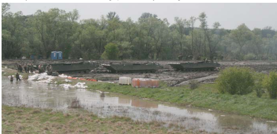
13-148. kép. Szárazföldi anyagszállítás terepen. Az is előfordul, hogy a különben jól hasznosítható PTSZ-ek elakadnak, egymást próbálják kihúzni.
