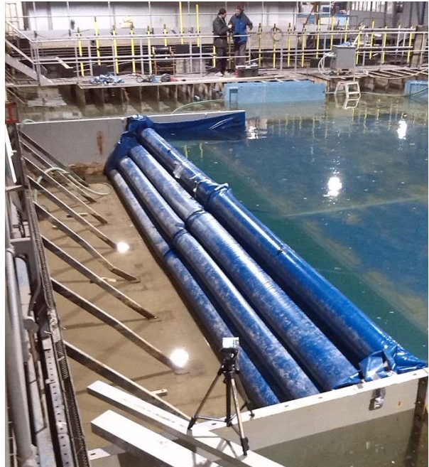
13-20. b. kép. Inflater mobil árvízvédelmi gát Wallingfordban az ellenőrző méréseken
