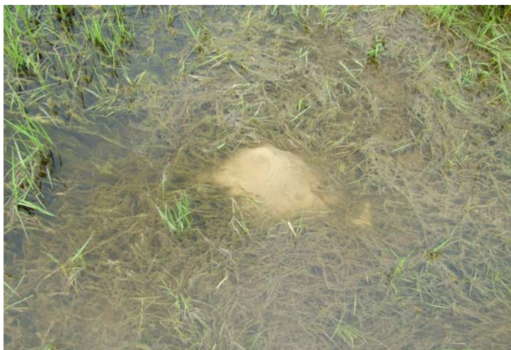
13-91. kép. Alacsony vízhozamú törpebuzgár, lesz-e belőle óriás?
