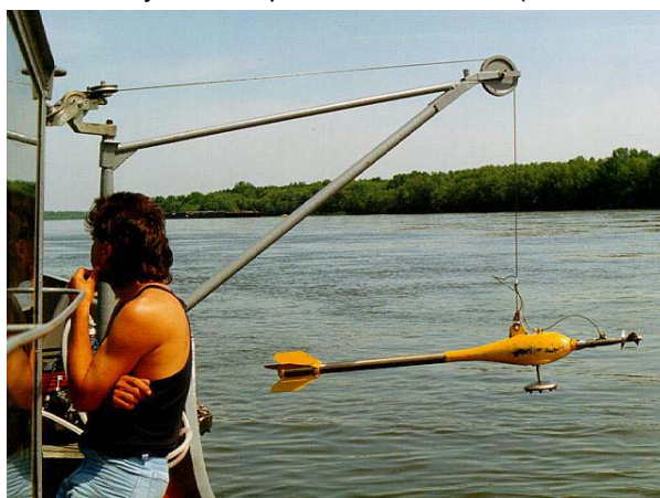
2-17. ábra. Vízsebességmérő műszer ólomsúllyal, talpérzékelővel
