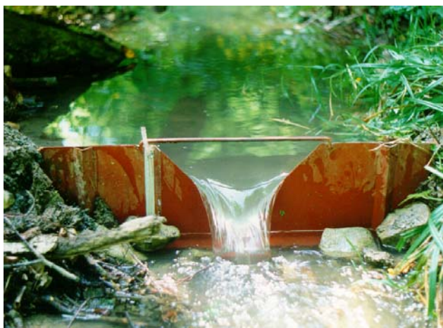
2-11. ábra. Háromszögszelvényű hordozható mérőbukó (Thomson-bukó)
