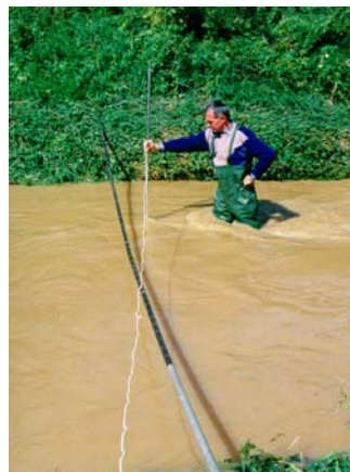
Vízhozammérés vízben állva
