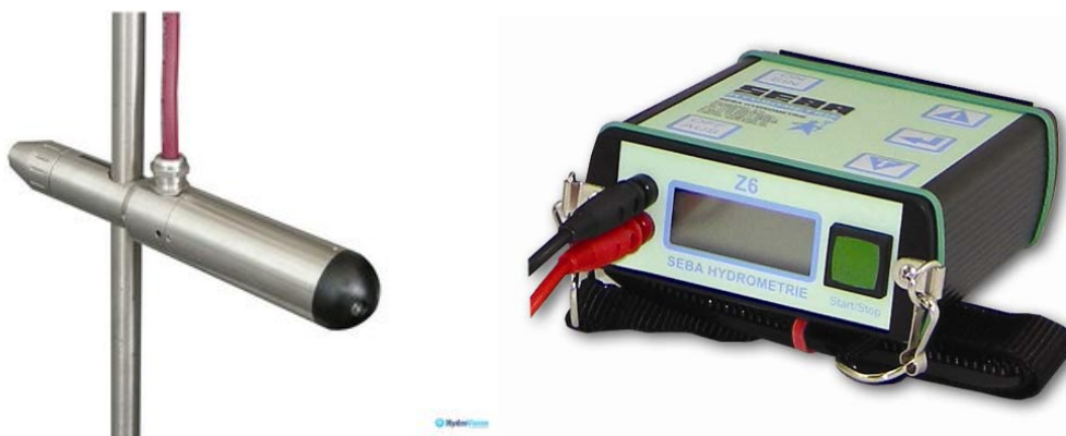
2-14. ábra. Indukciós vízsebesség mérő műszer (Seba Flow típus)
