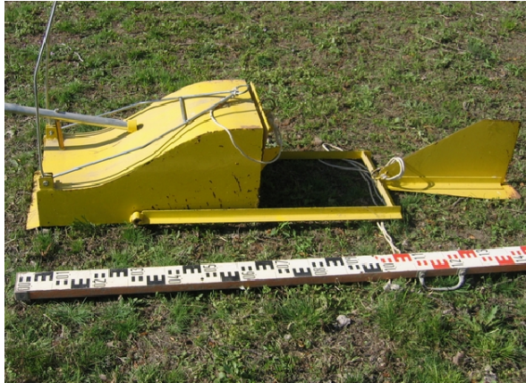
2–31. ábra. A Károlyi-féle „kis” görgetett hordalék mintavevő
