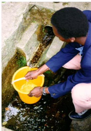
2-10. ábra. Vízhozammérés köbözéssel
