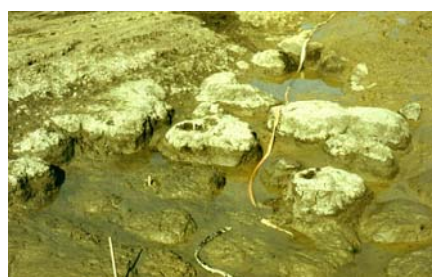
5–15. kép. Diszperzív talajrögök a Kettős-Körös 1980. évi gátszakadásánál, a gát alapjában
