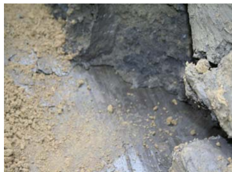
5–1. kép. Csúszólapon kialakuló repedés (Hármas-Körös jp., Istvánházi suvadás, KÖTIVIZIG)
