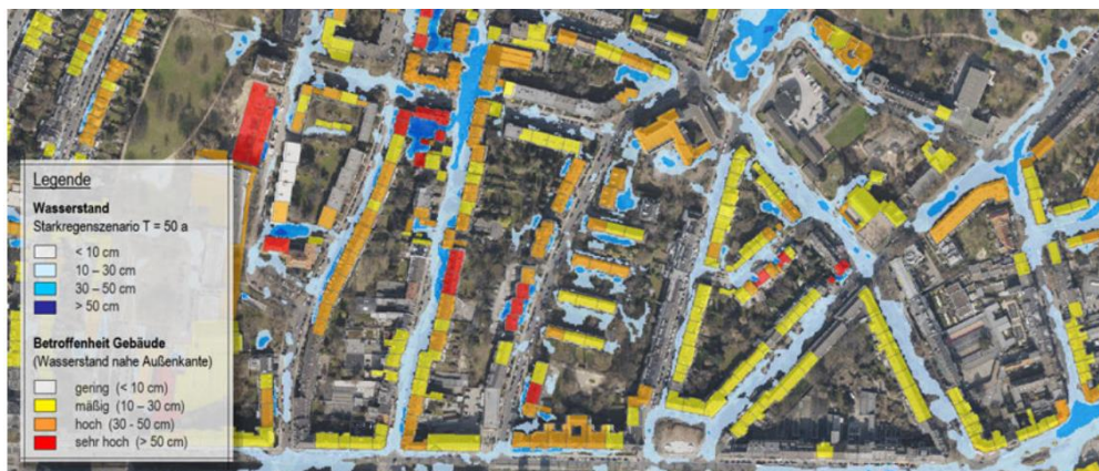
Abb. 13 Beispiel einer Intensitätskarte aus Deutschland mit Angabe der Betroffenheit der Gebäude [DWA M 119 (2016)]
