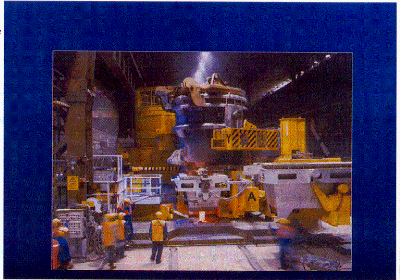
Kuva 7. Jatkuvavalukone 6:n valutaso
