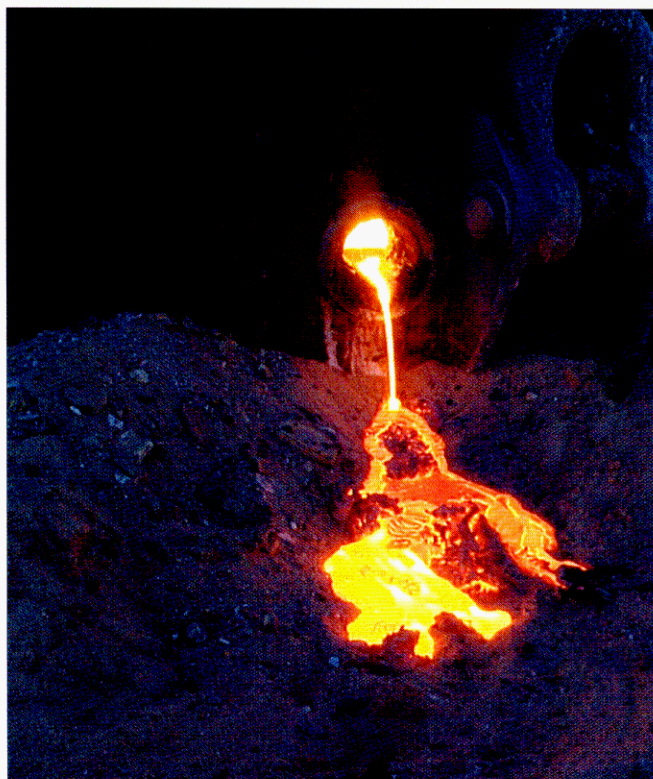
Kuva 6. Sulaa rautaoksidipitoista tuotetta masuunipölyllä tehdyistä kokeista Fundia Koverharista.
