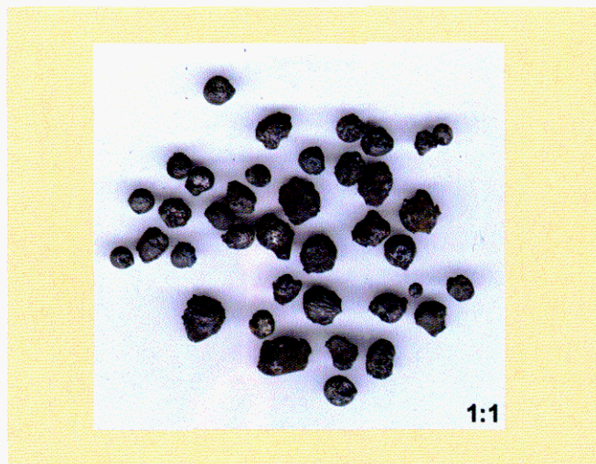
Kuva 4. Ferrokromilla tehdyistä kokeista koeuunin seinästä löytyneitä metallisia ferrokromiaglomeraatteja. Aglomeraattien halkaisija 3-8 mm. Käsitellyn pölyn partikkelikoko <0,1 mm. Figure 4. Metallic ferrochromium agglomerates found inside trial furnace, size is 3-8 mm. The treated dust had a particle size <0.1 mm.
