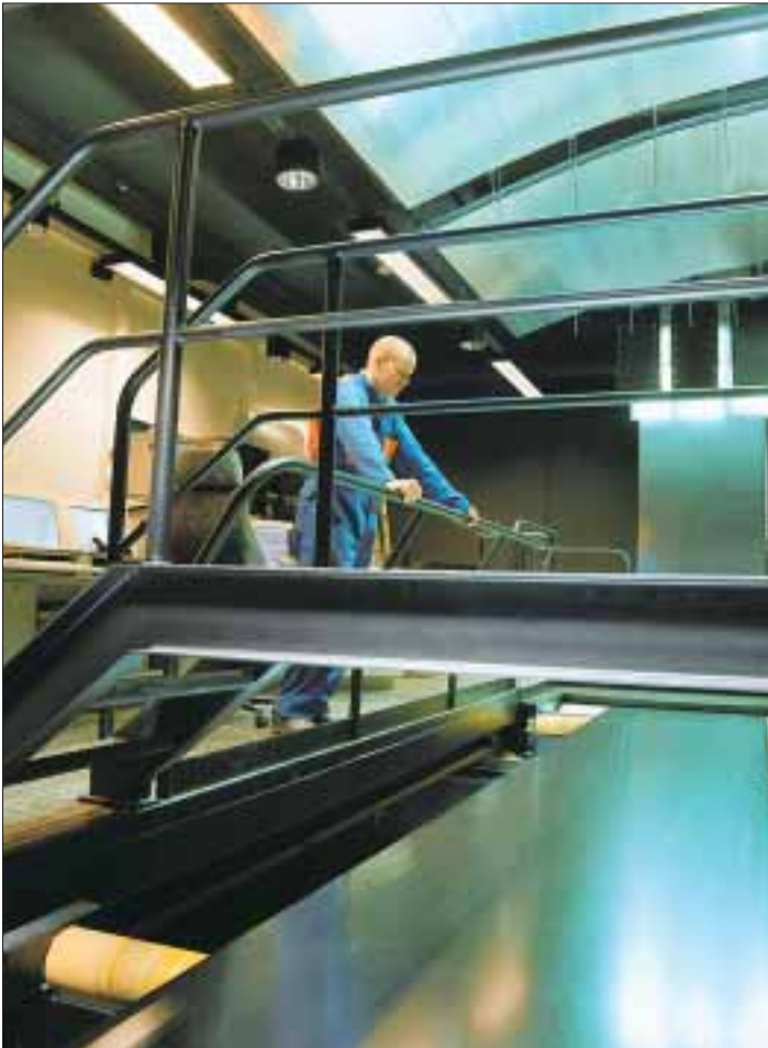
Sinkityksen laatua seurataan myös visuaalisesti. Laaduntarkastaja Ari Tuomola seuraa silmä tarkkana pinnanlaatua uuden sinkitystehtaan laaduntarkastus-huoneessa.
