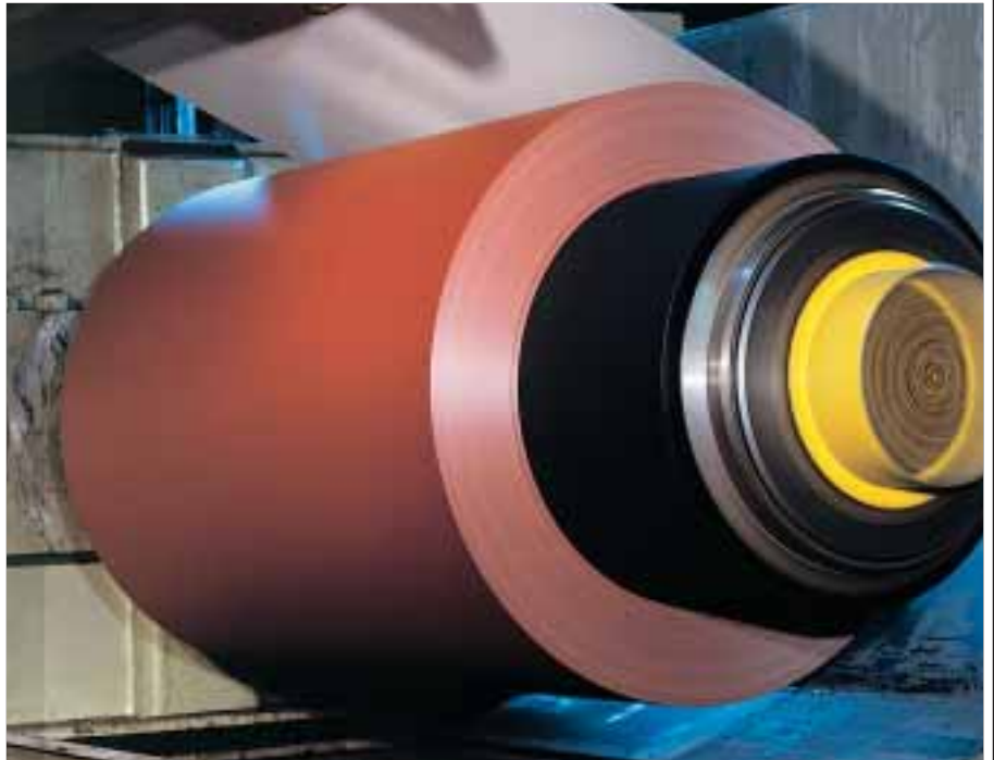
Pinnoitettu teräslevy kiertyy loppukelaimelle.
