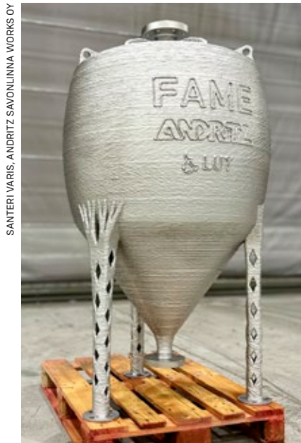
Noin 300-kiloisen paineastian halkaisija on 900 mm ja korkeus 1600 mm.
