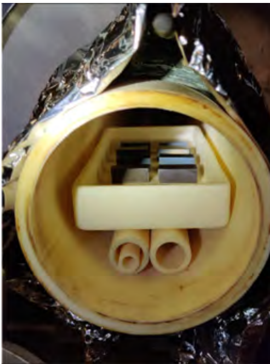
a) Kuva 3. a) Kokeen toteutus putkiuunissa. b) Esimerkinäytteet 1000 h kokeen jälkeen ammoniakkipitoisessa kaasuatmosfäärissä (14NH 3 -Ar, 400°C). Ennen koetta näytteet olivat väriltään metallinharmaita.
