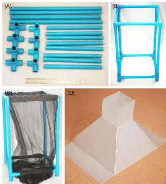
รูปที่ 9.24 ภาพจากกล้องถ่ายภาพดิจิทัล แสดงกรงดักแมลงวันที่ผู้นิพนธ์และคณะประดิษฐ์ขึ้น (A) โครงกรงทำจากท่อน้ำประปา polyvinyl chloride (B) โครงกรงที่ประกอบเสร็จแล้ว (C) ถุงเก็บแมลงวัน (D) กรวยทางเข้ารูปโดม (ภาพโดยคม สุคนธธรรม)
