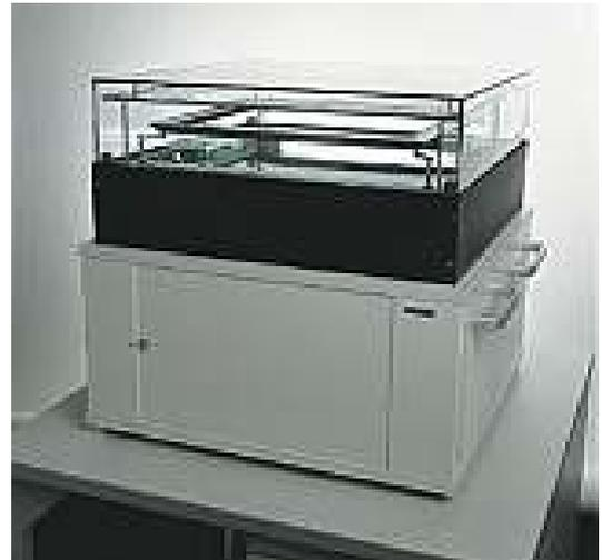
Die Abbildung unten zeigt einen Schnitt durch die Nebelkammer, an dem man sich die Wirkungsweise leicht klarmacht: Der Alkohol verdampft und diffundiert vom oberen, warmen Bereich der Kammer zum kalten Kammerboden. Dort kondensiert der Alkoholdampf und fließt in den Vorratsbehälter zurück.
