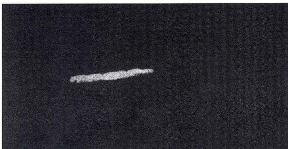
Nebelspur, erzeugt von einem  $\alpha$ -Teilchen
