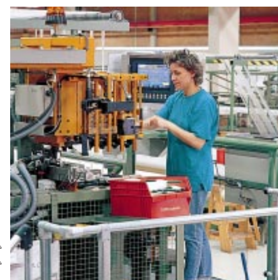
Tampereen tehtaan uusiin kutomakone on alapuolinen varsikone, jossa on tietokoneohjaus ja automaattinen puolanvaihto. Kuvassa kutoja Tarja Aaltonen.
