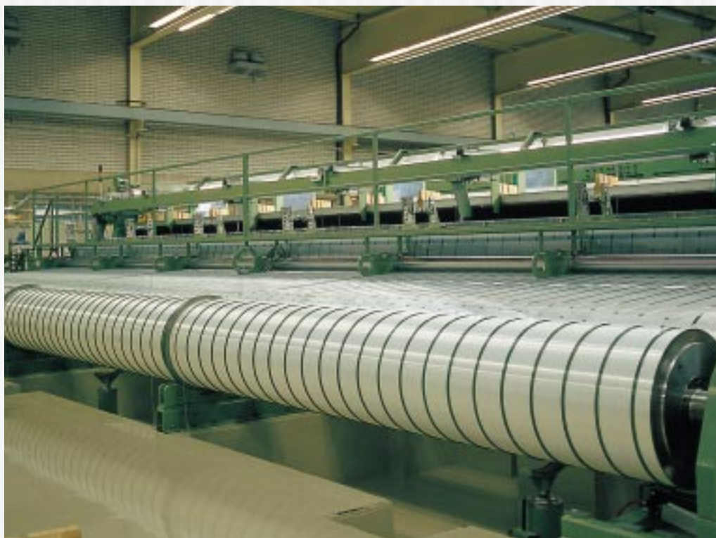
Uusi viirakutomakone käynnistyi Juankoskella elokuussa. Koneen kudontaleveys on 13,5 m ja se tekee viiroja nopeille ja leveille aikakauslehtipaperia valmistaville kitaformerikoneille.
