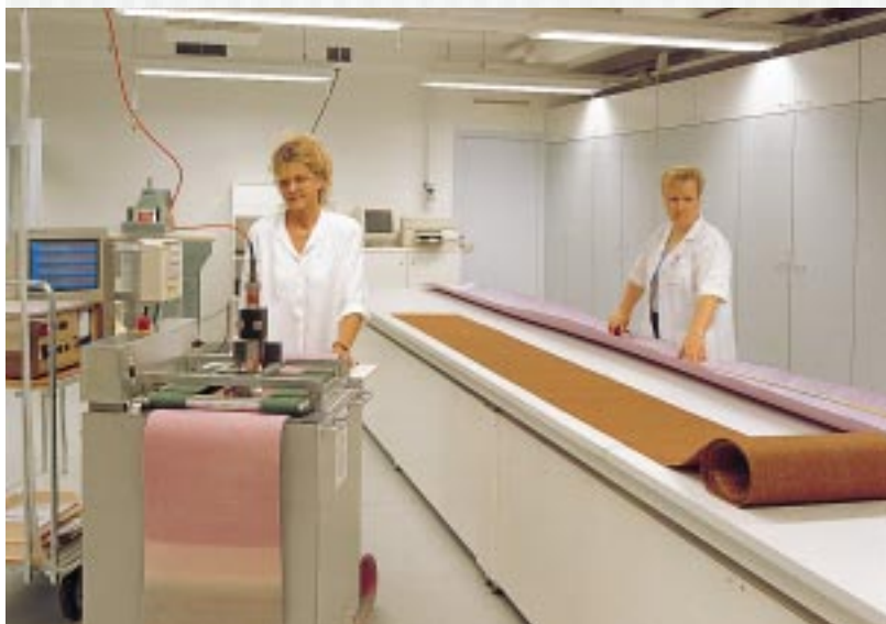
Undessa laboratoriossa Pirjo Nurminen (edessä) ja Sinikka Teppo tekevät käytetyn huovan profiilimittausta ja visuaalista tarkastusta. Huovasta mitataan neliömassa, paksuus, ilmanläpäisy ja bulkki.
