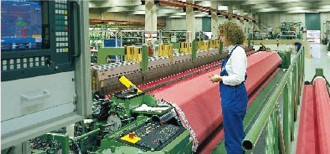
Tampereen tehtaan kutomon kapasiteettia on lisätty. Uuden kuivatusviirakoneen nopeus on 75 iskua minuutissa. Kuvassa Mari Viitala.
