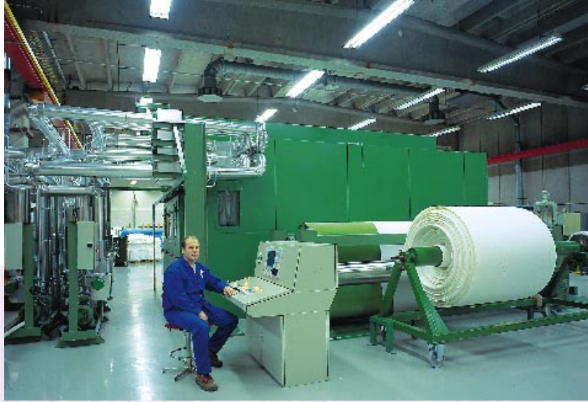
Suodatinkangasyksikön viimeistyskapasiteettia on kasvatettu bankkimalla tebokas, jatkuva-toiminen lämpökäsittelykone. Kuvassa Heikki Toivainen.
