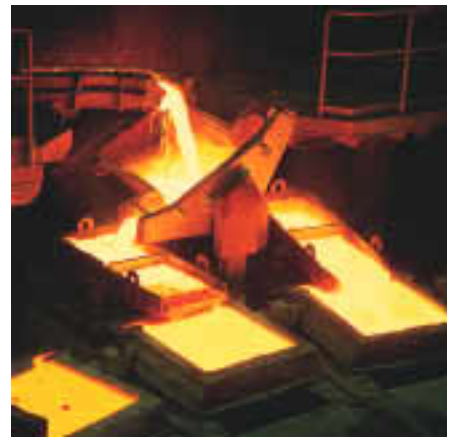
Harjavalta tuottaa raakakuparia, jonka kuparipitoisuus on 99,2 %. Kuvassa raakakupari valetaan anodeiksi, jotka toimitetaan pääosin Poriin elektrolyttisesti puhdistettavaksi.
