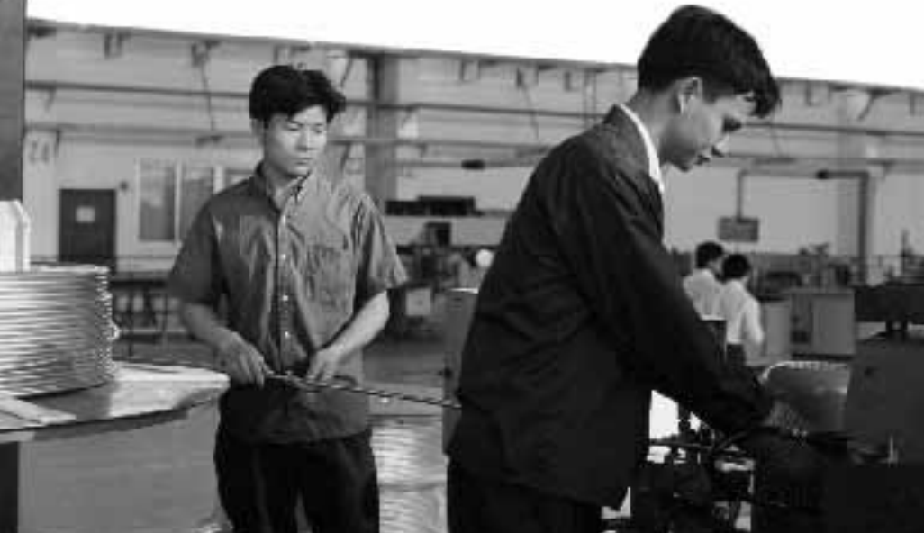
Outokummun teknologiaosaamista on siirretty lähelle asiakasyhtiöitä mm. Kiinaan rakennettuun putkitehtaaseen, jossa valmistetaan vaativia, sisältä rihlattuja ilmastointiputkia. Kuvassa Chen Young (oik.) ja Liang Lian kelaamassa putkea.
