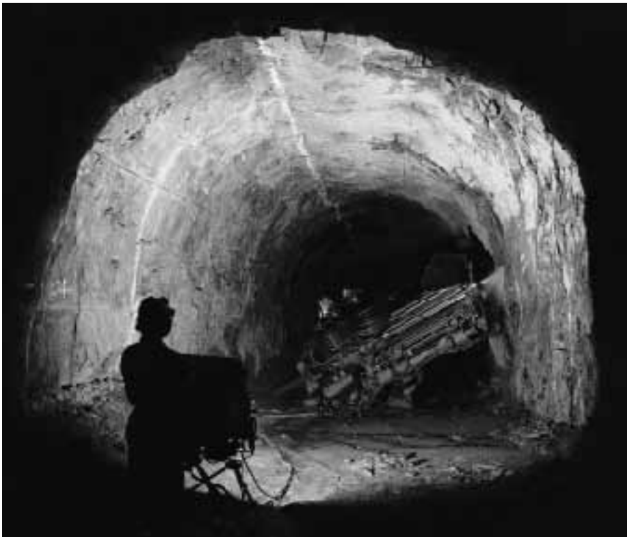
Kauko-ohjattujen koneiden hyödyntäminen on edistänyt työolosuhteiden paranemista kaivostyössä. Kuvassa tuotantoperän poraus käynnissä Taran sinkkikaivoksella Irlannissa.
