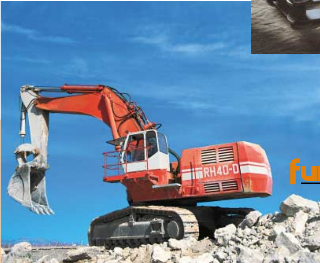
Kaivinkoneissa käytetään Fundian tankoterästä kauhassa ja telaketjuissa sekä kovakromattuja tankoja hydraulikkalaitteissa.
