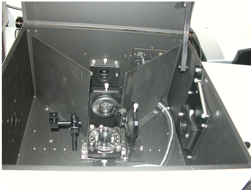
Figura 47. Interior del compartimento donde se coloca la muestra a medir.
