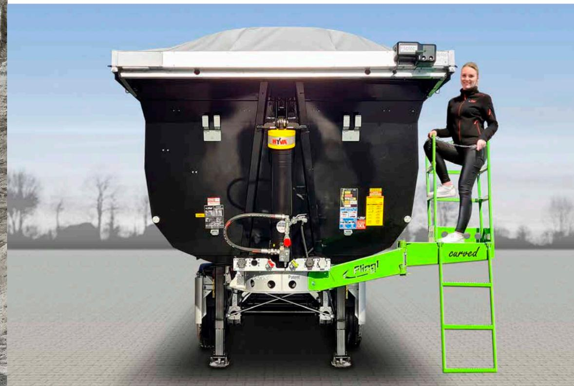
Das neue Stehpodest S.T.E.P. lässt sich in Kombination mit dem elektrischen Fliptop-Schiebeverdeck an alle Fliegl Sattelkipper montieren, unabhängig von der Muldenart und -höhe.
