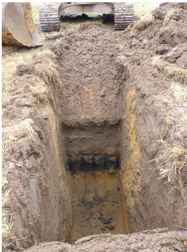
Photo 2: lentille d'argile intercalée au sein de sables grossiers et de sables fins en partie supérieure de la terrasse d'alluvions anciennes (sondage PM2 réalisé le 18/02/2015)
