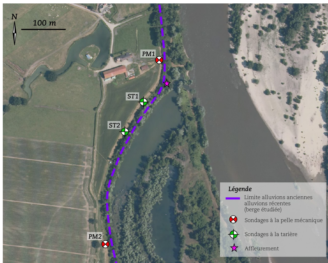
Illustration 10: implantation des sondages à la pelle mécanique et à la tarière réalisés le 18/02/2015, et localisation de l'affleurement de la terrasse d'alluvions anciennes
