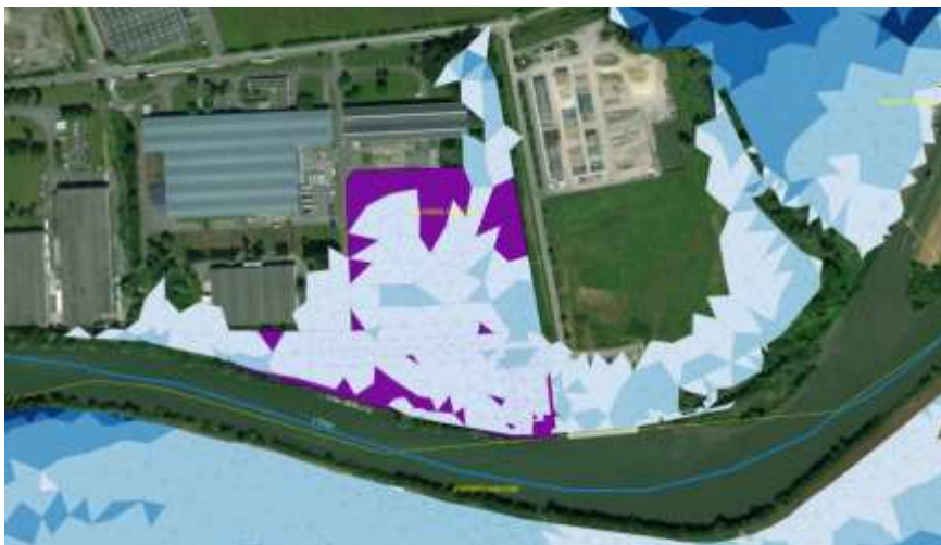
Hauteurs de submersions calculées pour la crue Q50 – détail de l'emplacement de la future plateforme de BSO
