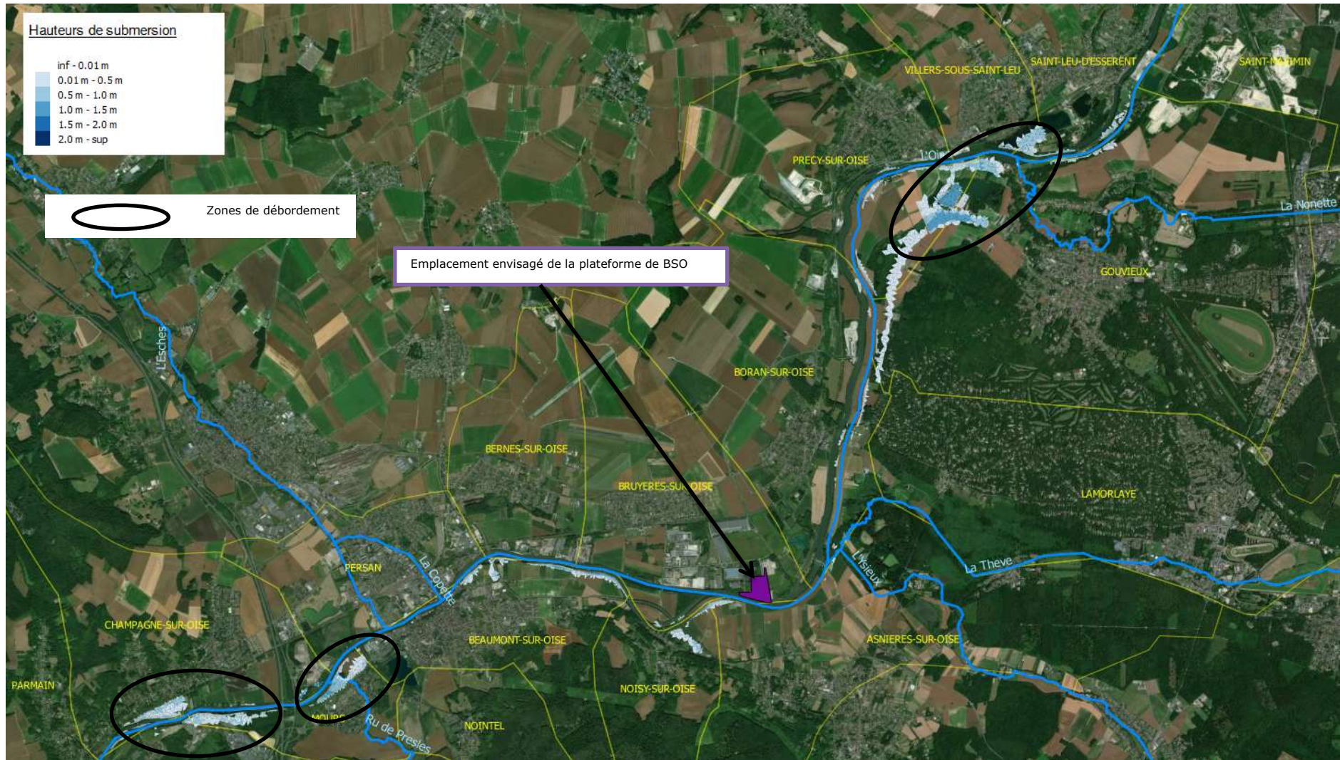
Hauteurs d'eau maximales calculées pour la Q10
