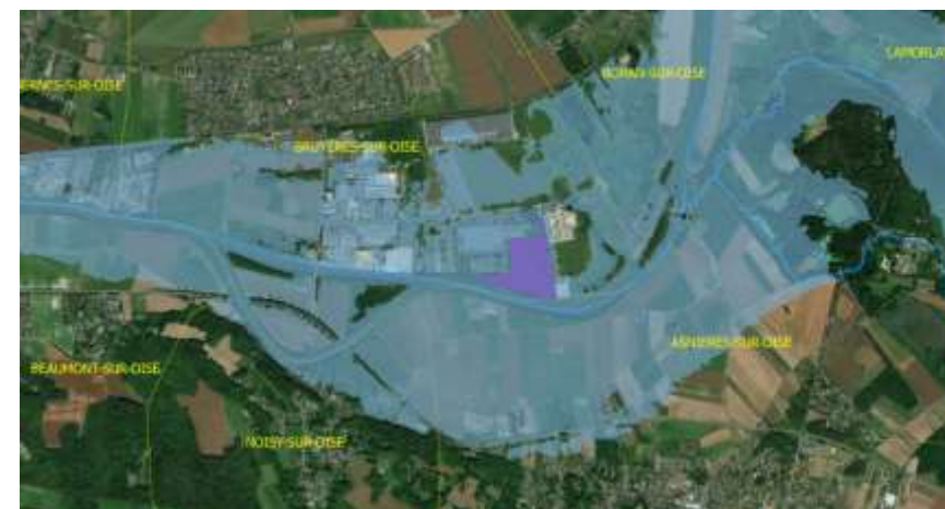
Zone d'inondation en Q100 synthétique (projection sur le lidar)
