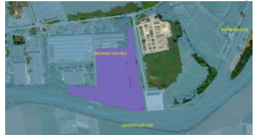
Étendue de la zone inondable au niveau de la plateforme pour une crue centennale (janvier 1910)
