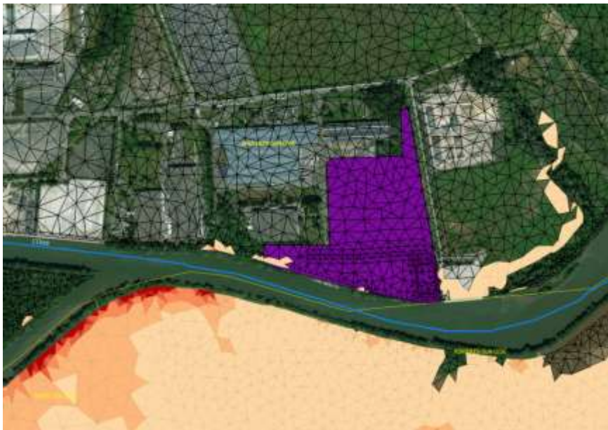
Vitesses au droit de la plateforme de BSO – Q20 et Q30
