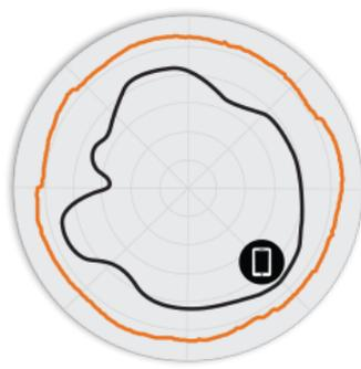
Figura 4. R730 2,4 GHz: patrones de antena en elevación
