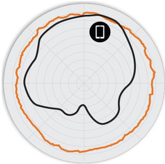
Figura 3. R730 5 GHz: patrones de antena en acimut
