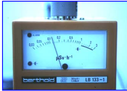
Fig.4.4.: Detector BERTHOLD LB-130-1B . Detalle zona de lectura
