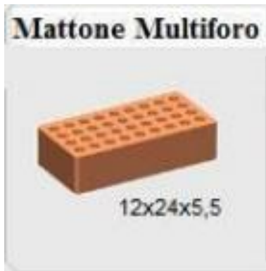
Figura 25. Misure mattone multiforo
