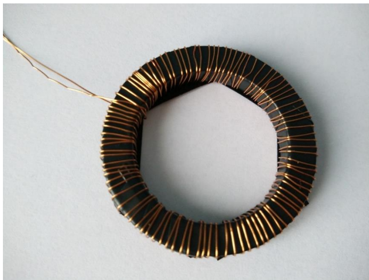
Fig.31 Avvolgimento secondario del campione toroide
