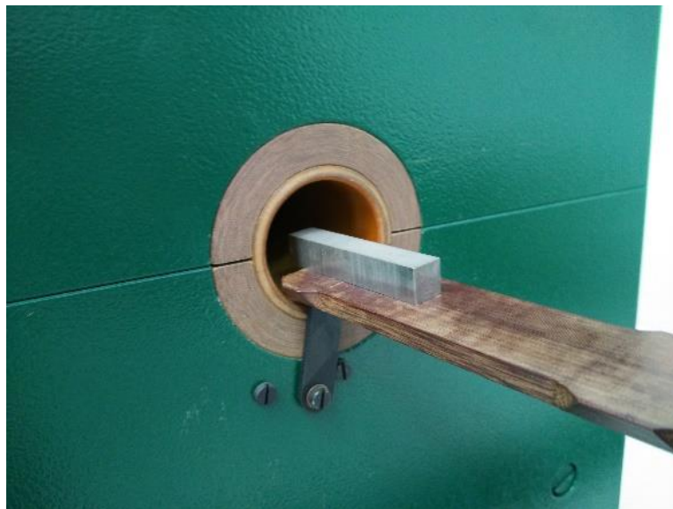
Fig.38 Inserimento del campione nella bobina del Koerzimat 1.095.
