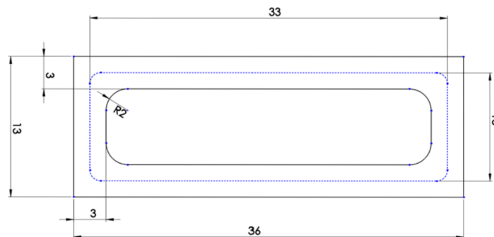
Fig.61 Campione in analisi con lunghezza del percorso medio tratteggiato (quote in millimetri)
