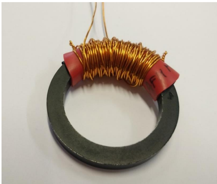
Fig.28 Avvolgimento campione toroide per misura termografica
