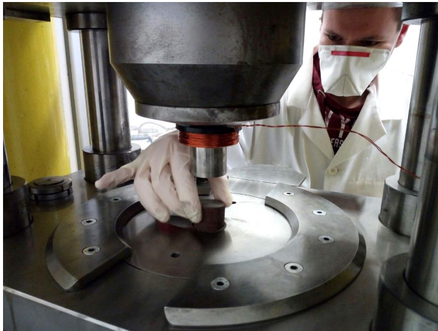
Fig.101 Caricamento dello stampo con prima pressatura a mano della polvere
