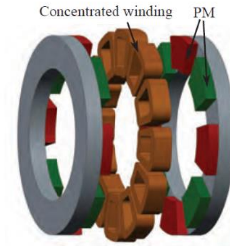
Fig.13 Macchina con doppio rotore esterno, statore interno senza nucleo
