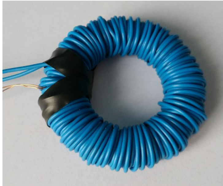
Fig.32 Avvolgimento primario del campione toroide
