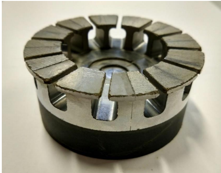
Fig.110 Statore al termine della lavorazione di fresatura
