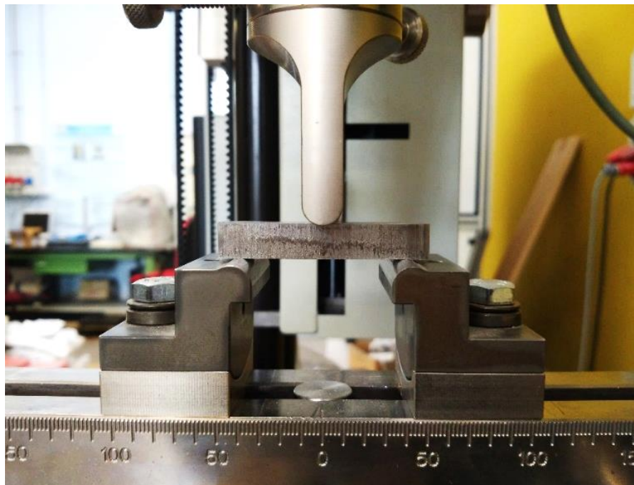
Fig.41 Campione 'charpy' sottoposto alla prova a tre punti
