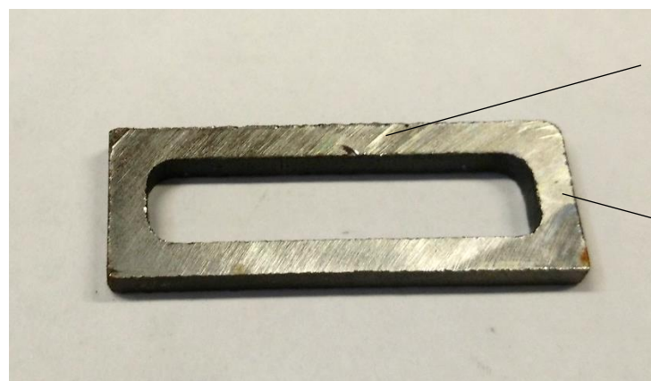
Fig.29 Struttura di un campione in S.M.C. utilizzato per valutare l'isotropia con misura termografica
