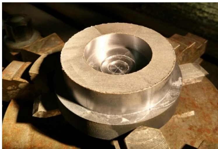
Fig.107 Fresatura diametro massimo esterno comprendente la scarpa e alloggiamento per cuscinetto
