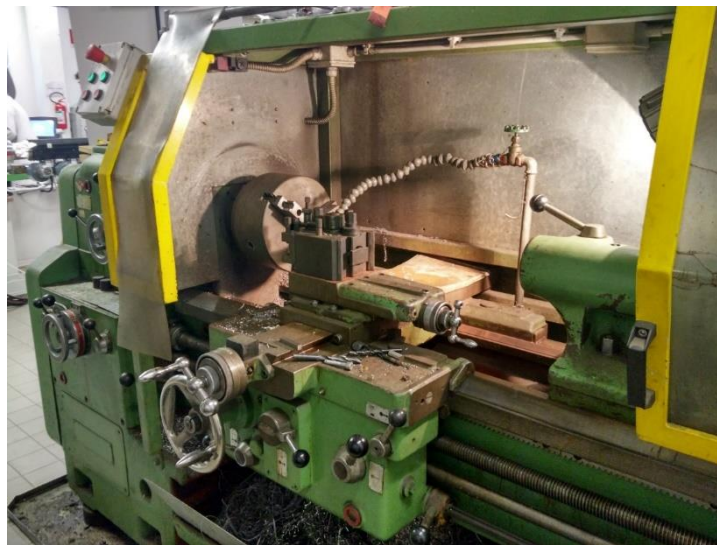
Fig.97 Tornio per ottenere l'albero della macchina
