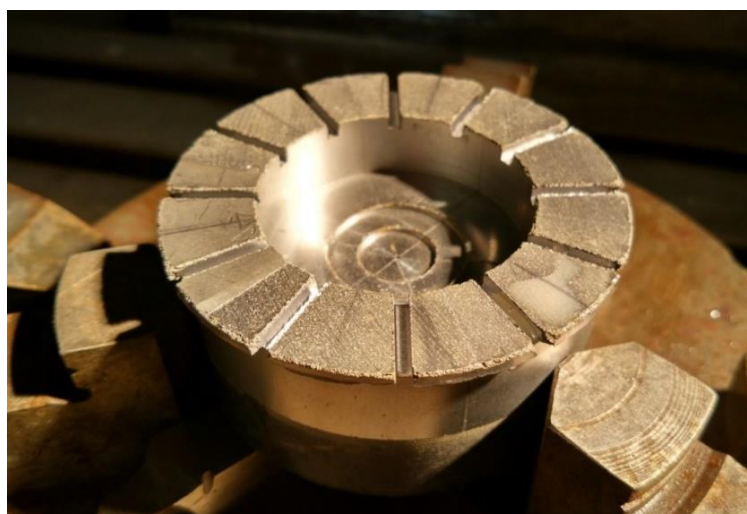
Fig.108 Diametro esterno e apertura cave
