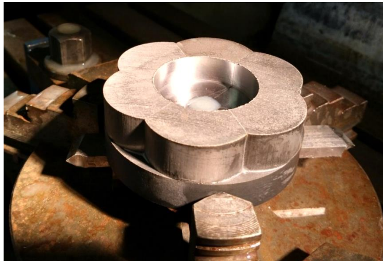
Fig.106 Fresatura al diametro interno di statore
