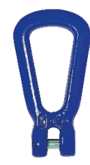
Typ TWN 1827 Tragfähigkeit: bis 6.700 kg Güteklasse 10 Aufhängeglied
