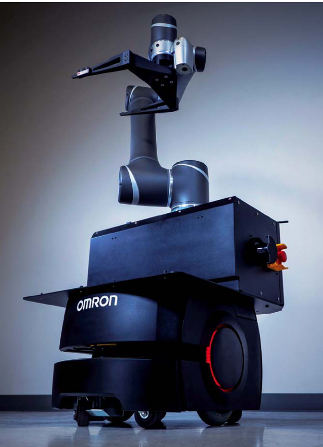
Die Cobots der TM-Serie lassen sich mit den autonomen, mobilen Robotern der LD-Serie kombinieren. Das heißt, die Cobots können immer dort arbeiten, wo sie gerade gebraucht werden.
