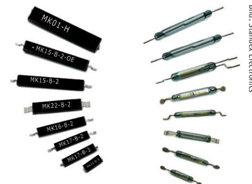
Standex Electronics bietet den nach Unternehmensangaben weltweit kleinsten SMD-Reed-Sensor an.
