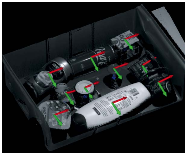
Die Identifikation der Anfahrposen im 3D Raum für den Roboter mit Sauggreifer.
