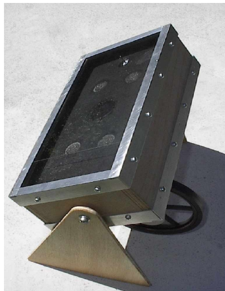
Abbildung 12: Flachplatten-Stirlingmotor Vieb-4 für den Eigenbau von DIETER VIEBACH [Vie]
